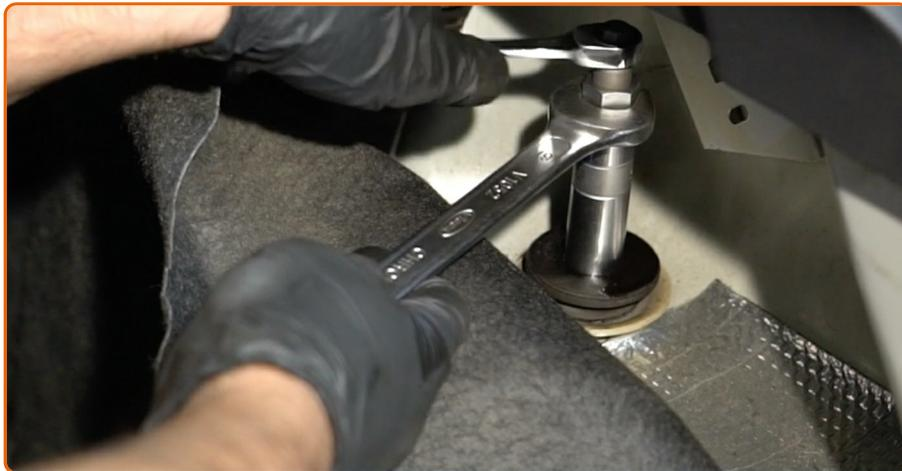
Dévissez l'attache supérieure de l'amortisseur. Servez-vous d'un embout d'amortisseur DDN°6 Utilisez une douille n° 16. Utilisez une clé à cliquet.
