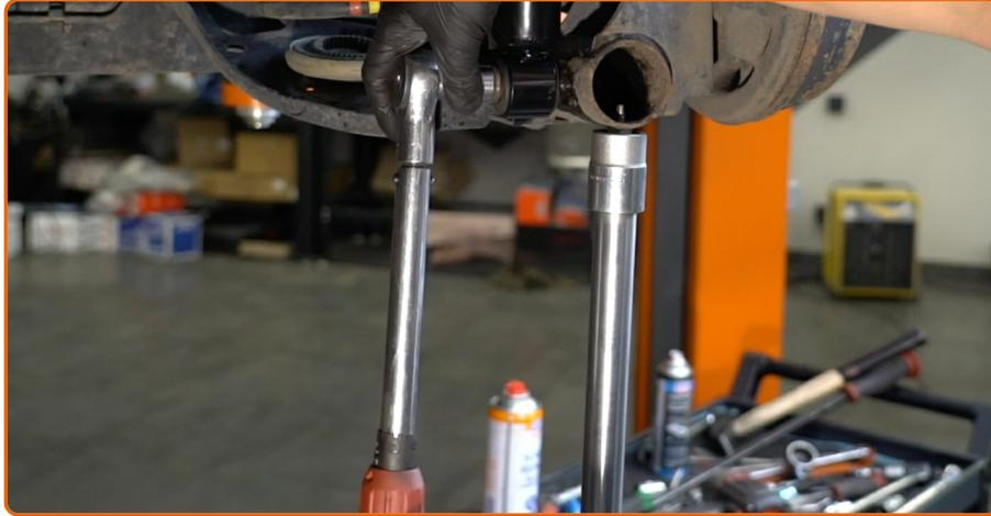
Serrez l'attache inférieure de l'amortisseur. Utilisez une douille n° 18. Utilisez une clé dynamométrique. Serrez-le jusqu'à 85 Nm.
