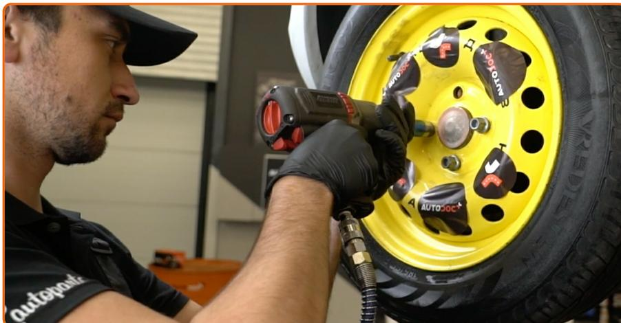
Vissez les boulons de la roue. Servez-vous d'une douille à choc pour roue N°17.
