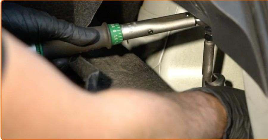
Serrez l'attache de l'amortisseur supérieur. Servez-vous d'un embout d'amortisseur DDN°6
