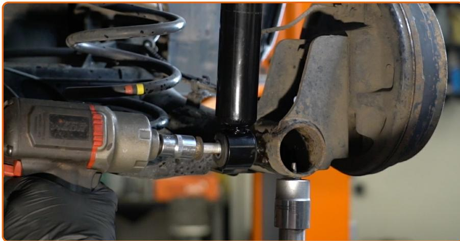
Vissez la fixation inférieure de l'amortisseur. Utilisez une douille n° 18. Utilisez une clé à cliquet.
