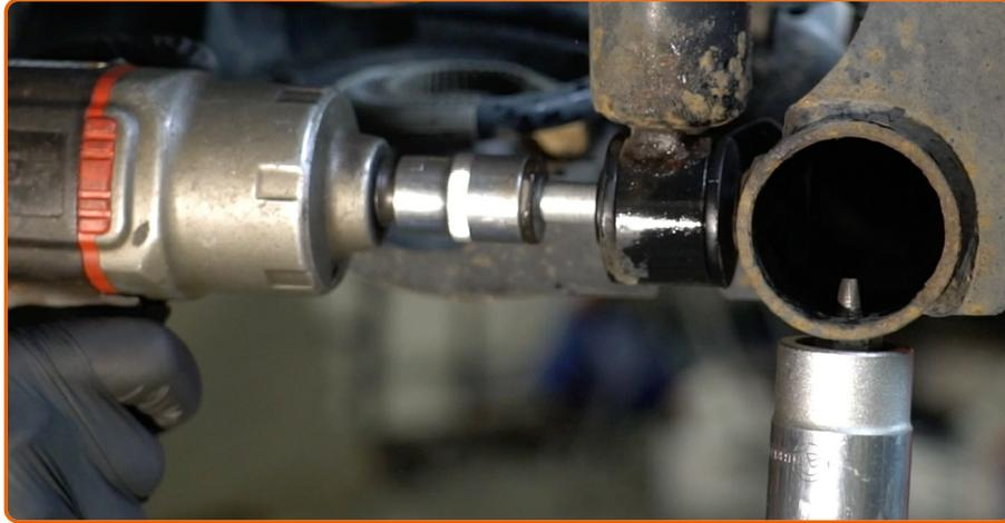
Dévissez l'attache inférieure de l'amortisseur. Utilisez une douille n° 18. Utilisez une clé à cliquet.
