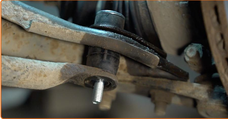
Installez une nouvelle barre, serrez les attaches.
