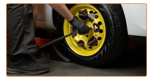
Desserrez les boulons de fixation de la roue. Servez-vous d'une douille à choc pour roue  $N^{\circ}17$ .
