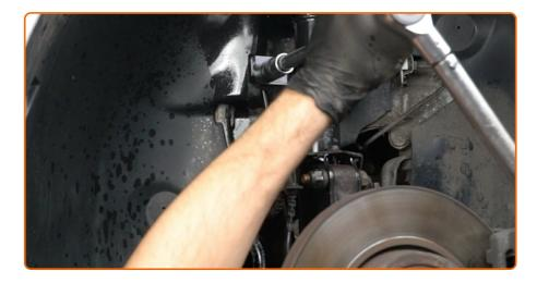
Serrez la fixation reliant la biellette à l'amortisseur. Utilisez une douille n° 17. Utilisez une clé dynamométrique. Serrez-le jusqu'à 65 Nm.
