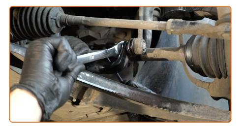
Dévissez la fixation reliant la biellette à la barre stabilisatrice. Utilisez une clé mixte de No.16 Utilisez la clé HEX n° H6. Utilisez une clé à cliquet.
