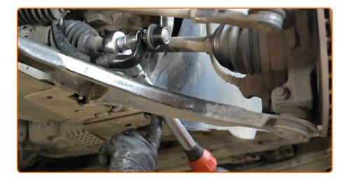
Serrez la fixation reliant la biellette à la barre stabilisatrice. Utilisez une douille n° 17. Utilisez une clé dynamométrique. Serrez-le jusqu'à 65 Nm.
