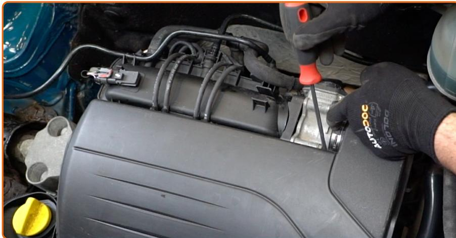
Vissez le collier qui serre le boîtier de filtre à air du moteur au boîtier papillon. Utilisez un tournevis plat.
