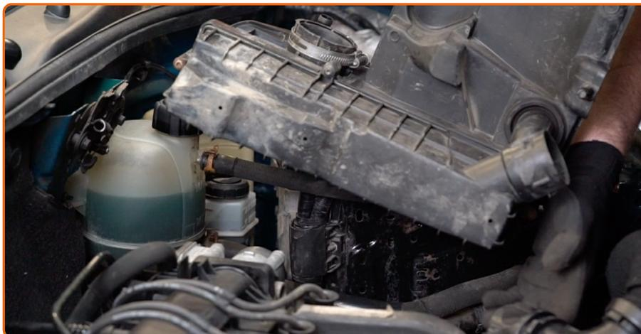
Réinstallez le compartiment du filtre à air.
