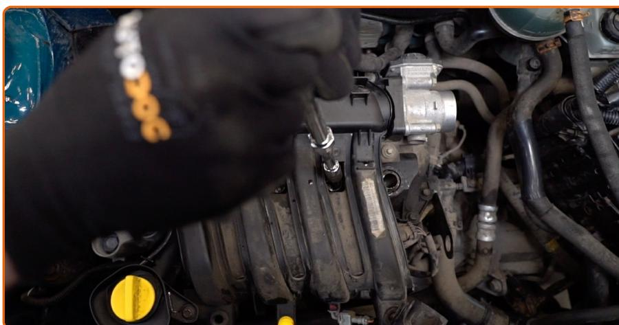
Vissez les nouvelles bougies et serrez-les. Servez-vous de la douille de bougie d'allumage n°16. Utilisez une clé dynamométrique. Serrez-le jusqu'à 25 Nm.
