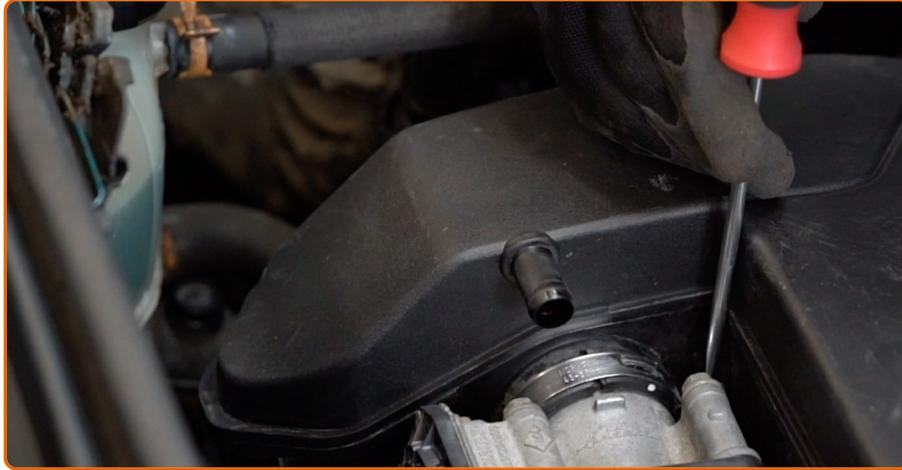
Dévissez le collier qui serre le boîtier de filtre à air du moteur au boîtier papillon. Utilisez un tournevis plat.
