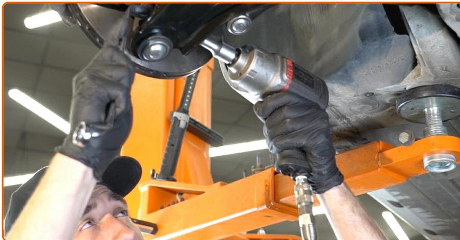
Vissez les fixations de la rotule. Utilisez une clé mixte de No.16 Utilisez une douille n° 16. Utilisez une clé à cliquet.
