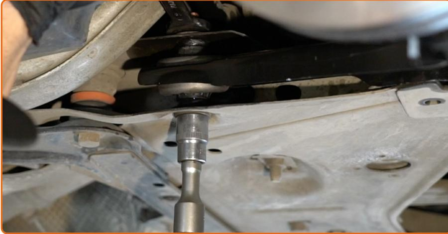
Vissez l'attache du bras arrière. Utilisez une clé mixte de No.18 Utilisez une douille n° 18. Utilisez une clé à cliquet.
