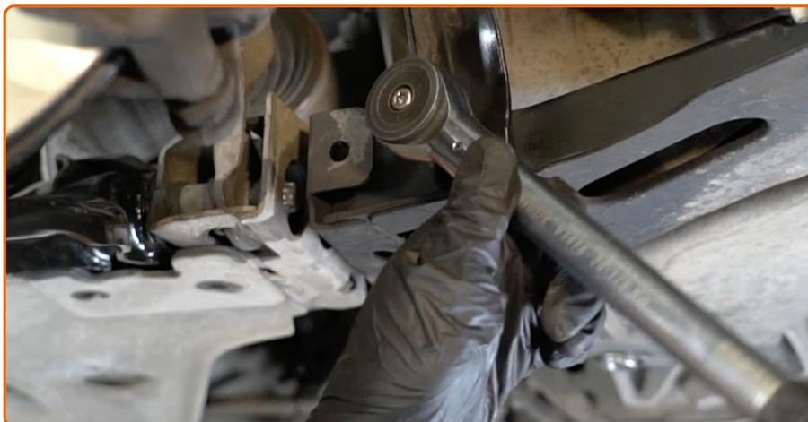
Serrez les fixations des supports de renforcement du sous-châssis. Utilisez une douille n° 13. Utilisez une clé dynamométrique. Serrez-le jusqu'à 57 Nm.
