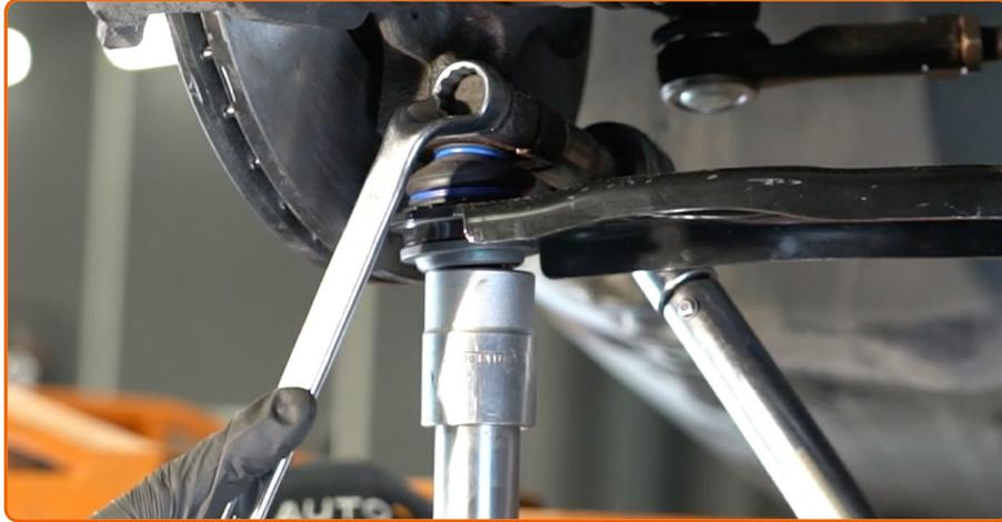
Serrez l'attache du joint rotule. Utilisez une clé mixte de No.16 Utilisez une douille n° 16. Utilisez une clé dynamométrique. Serrez-le jusqu'à 60 Nm.
