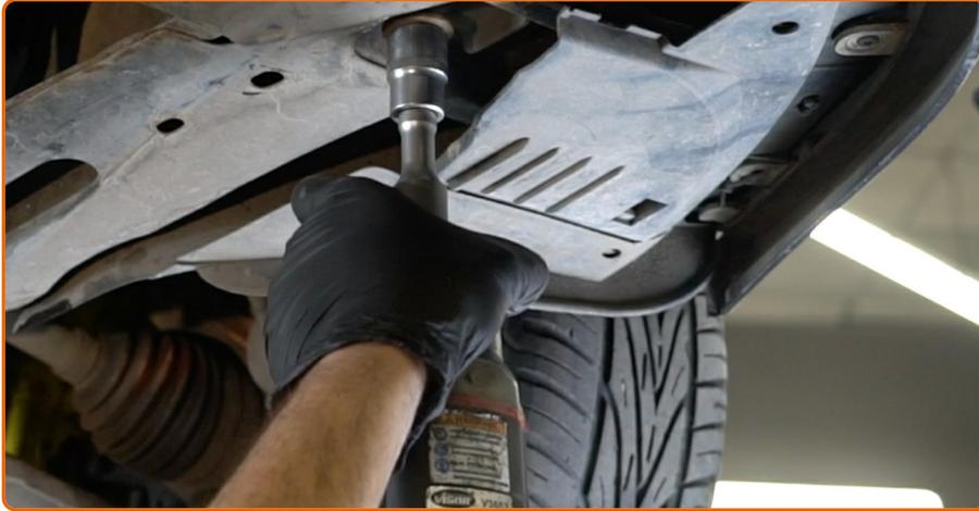
Desserrez l'attache de la sous-structure. Utilisez une douille n° 18. Utilisez une clé à cliquet.
