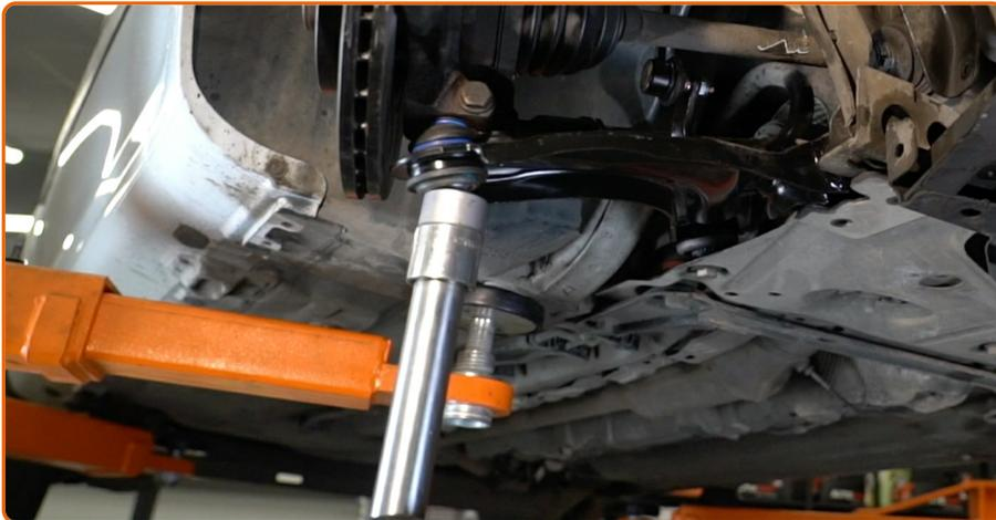
Soutenez le sous-châssis. Servez vous d'un cric à transmission hydraulique.
