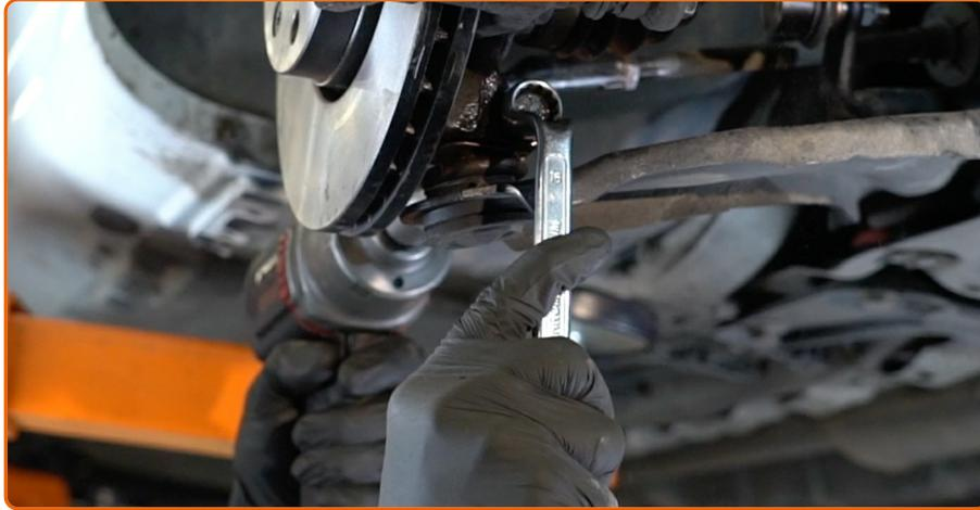
Dévissez l'attache entre le joint rotule et la fusée d'essieu. Utilisez une clé mixte de No.16
