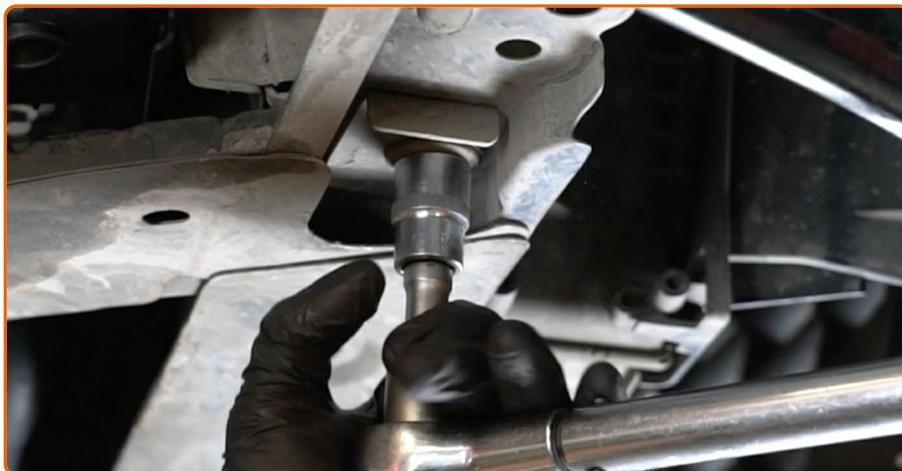
Serrez l'attache de la sous-structure. Utilisez une douille n° 18. Utilisez une clé dynamométrique. Serrez-le jusqu'à 72 Nm.
