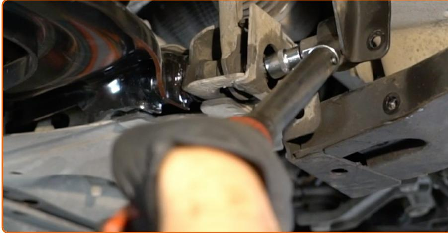
Serrez la fixation avant reliant le bras de commande au sous-châssis. Utilisez une clé mixte de No.18 Utilisez une douille n° E16. Utilisez une clé dynamométrique. Serrez-le jusqu'à 85 Nm.
