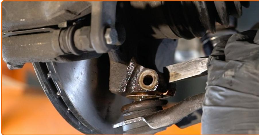
Relâchez la fixation reliant le joint à rotule au porte-fusée. Servez-vous d'un burin plat pour l'usinage des métaux. Servez-vous d'un marteau.
