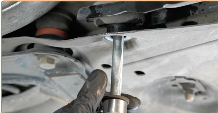
Retirez l'écrou de fixation.
