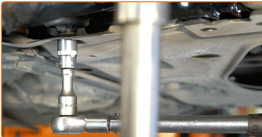
Serrez la fixation arrière qui raccorde le bras au châssis. Utilisez une clé mixte de No.18 Utilisez une douille n° 18. Utilisez une clé dynamométrique. Serrez-le jusqu'à 85 Nm.
