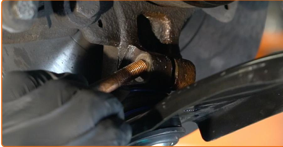
Installez l'écrou de fixation.
