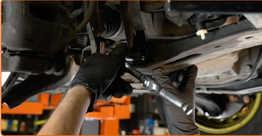
Dévissez les fixations des supports de renforcement du sous-châssis. Utilisez une douille n° 13. Utilisez une clé à cliquet.
