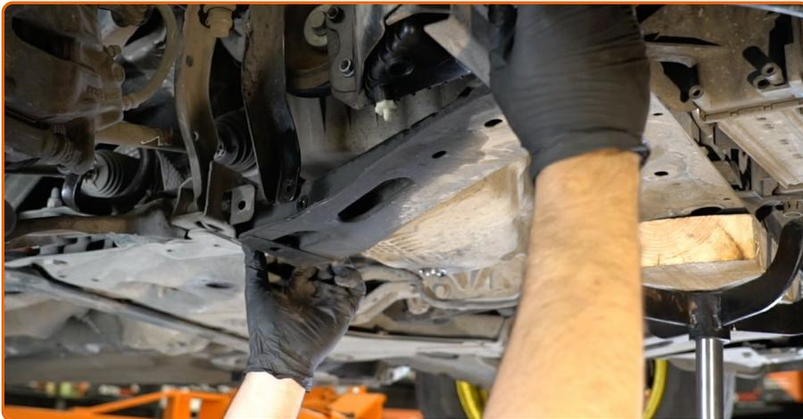
Détachez la traverse du sous-châssis avant.
