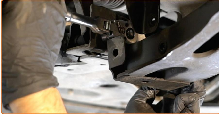
Dévissez la fixation arrière reliant le bras de suspension au cadre auxiliaire. Utilisez une clé mixte de No.18 Utilisez une douille n° 18. Utilisez un porte-taraud.
