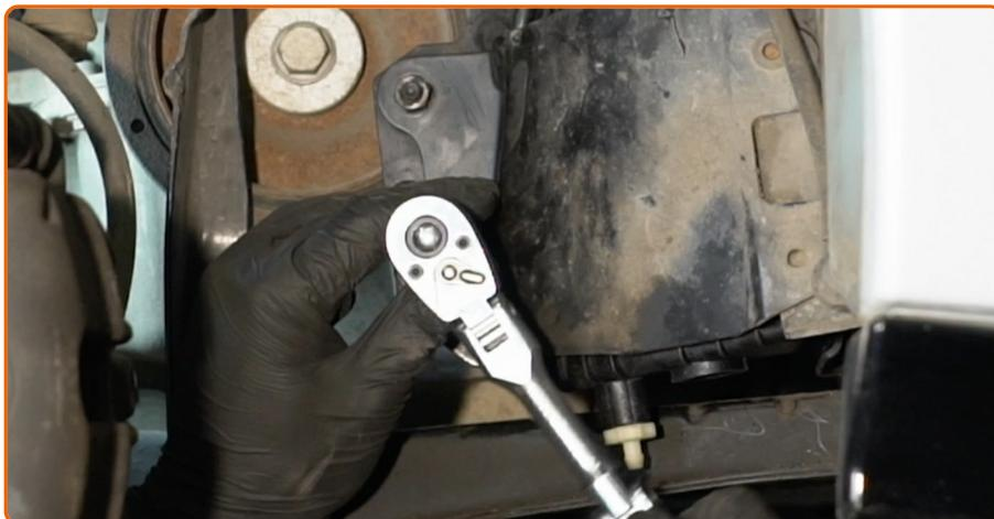
Vissez le boulons de fixation du support du filtre à carburant. Utilisez une douille n° 13. Utilisez une clé à cliquet.
