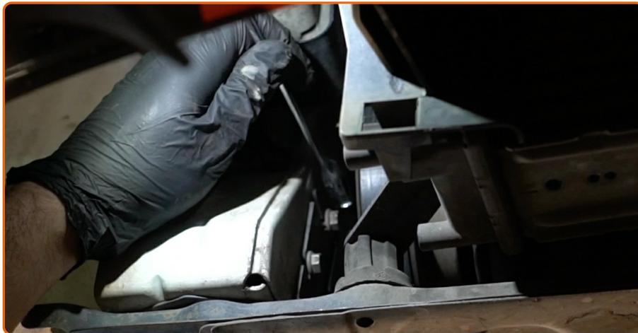
Dévissez les boulons de fixation du support du filtre à air. Utilisez une clé mixte de No.10
