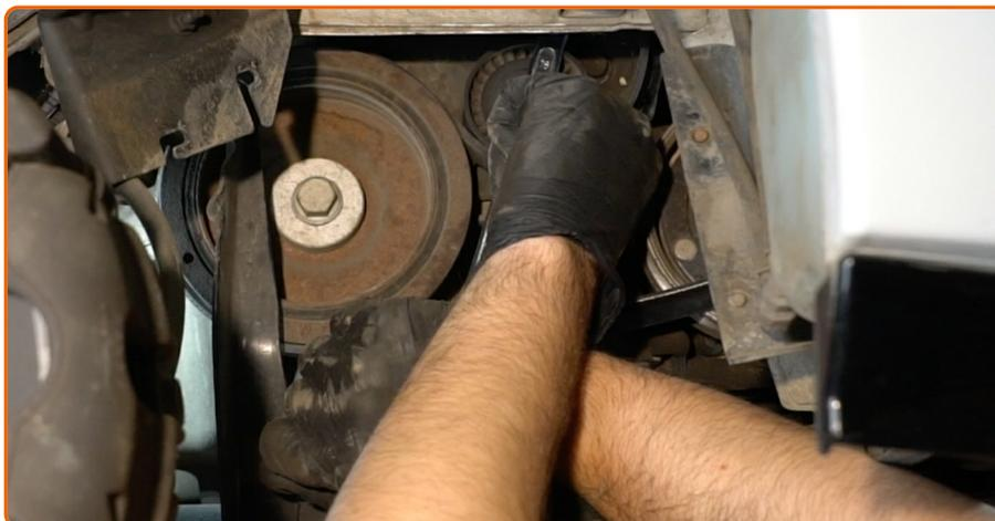
Installez la courroie striée en V sur le tendeur.
