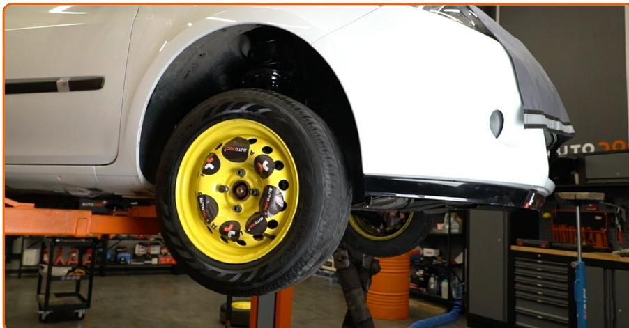
Abaissez la voiture et serrez les boulons de roue en ordre croisé. Servez-vous d'une douille à choc pour roue N°17. Utilisez une clé dynamométrique. Serrez-le jusqu'à 120 Nm.
