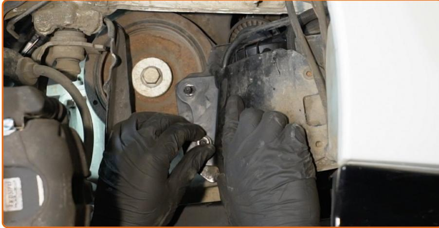
Installez le support de l'attache du filtre à carburant.
