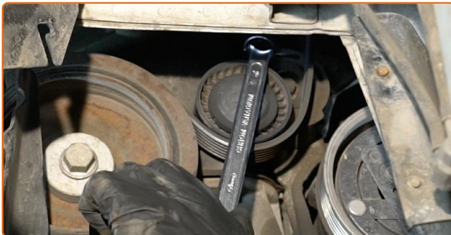
Mettez de côté la poulie de tendeur de la courroie en V crantée. Utilisez une clé mixte de No.16
