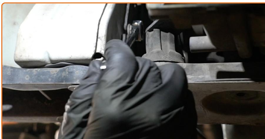
Vissez le boulons de fixation du support du filtre à carburant. Utilisez une clé mixte de No.10
