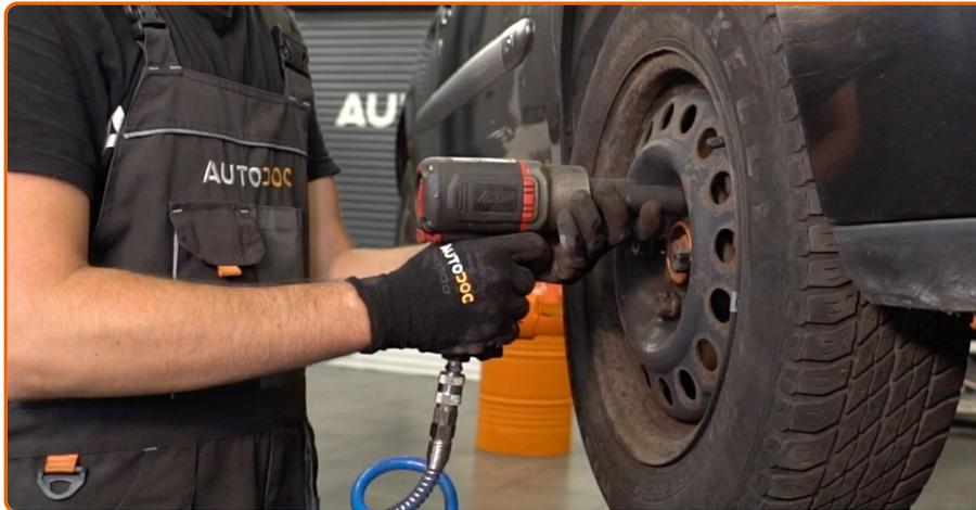
Vissez les boulons de la roue. Servez-vous d'une douille à choc pour roue N°19.
