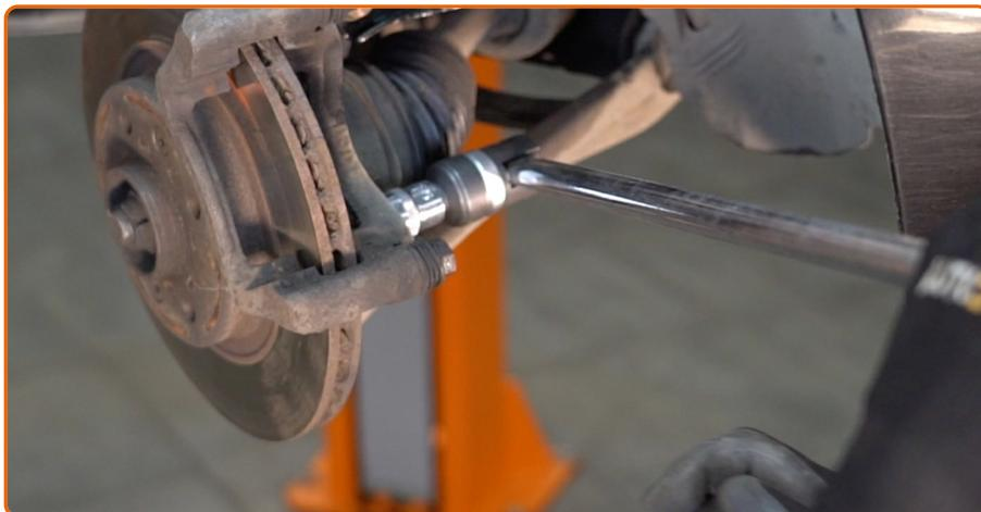
Dévissez l'attache du support d'étrier. Utilisez une douille n° 18. Utilisez une clé à cliquet. Utilisez un porte-taraud.
