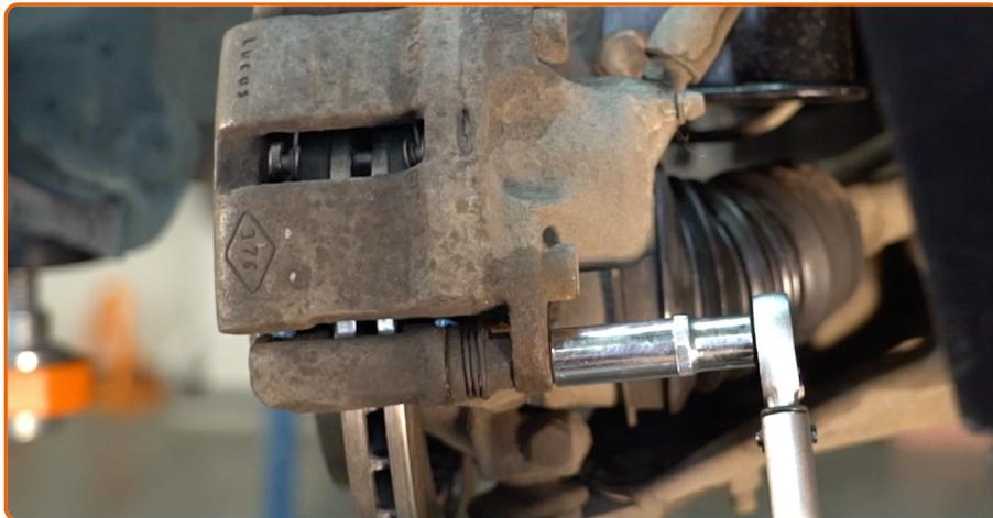
Installez l'étrier de frein et fixez-le. Utilisez une clé mixte de No.13. Utilisez une clé mixte de No.17. Utilisez une clé dynamométrique. Serrez-le jusqu'à 35 Nm.
