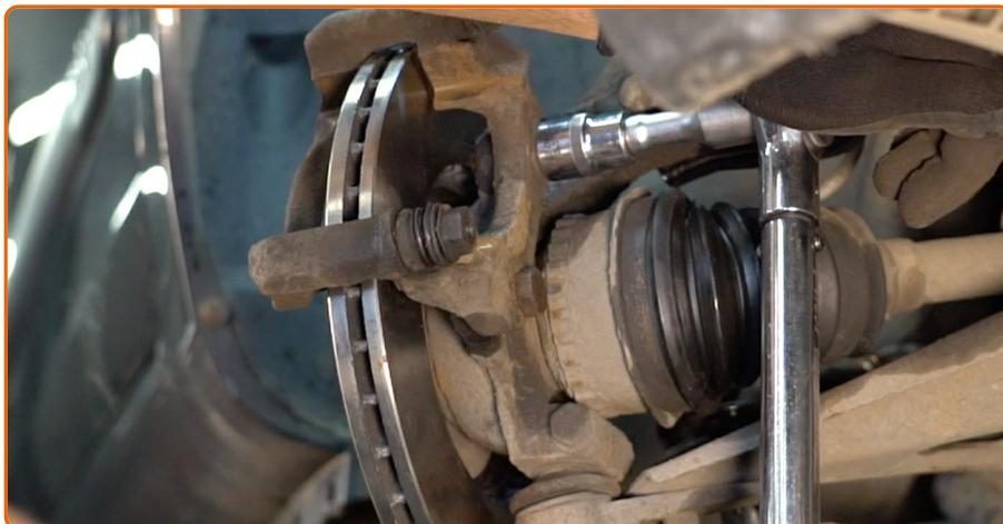
Serrez le support de l'étrier de frein. Utilisez une douille n° 18. Utilisez une clé dynamométrique. Serrez-le jusqu'à 75 Nm.
