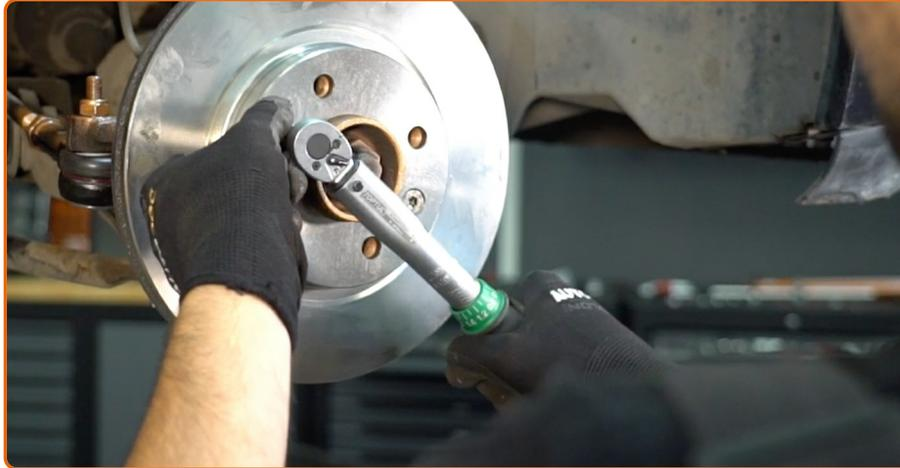
Serrez l'attache du disque de frein. Utilisez la mèche Torx T40. Utilisez une clé dynamométrique. Serrez-le jusqu'à 9 Nm.
