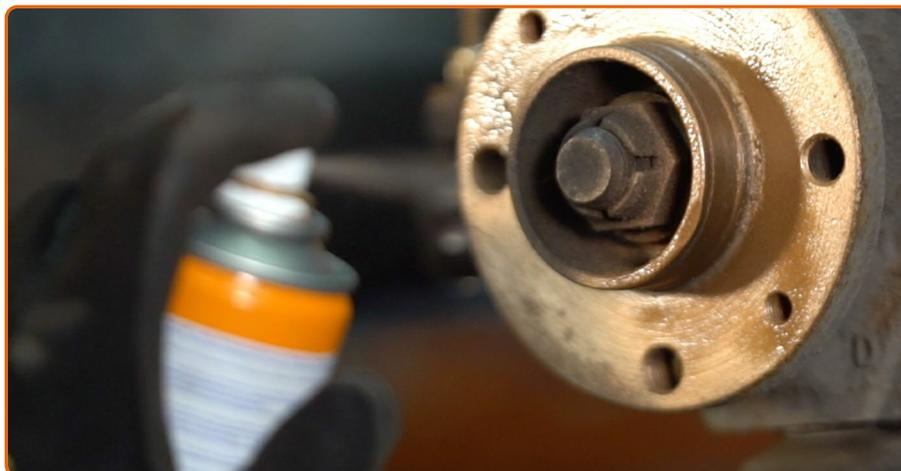
Nettoyez le moyeu. Utilisez une brosse métallique. Traitez la surface de contact. Utilisez de la graisse au cuivre.
