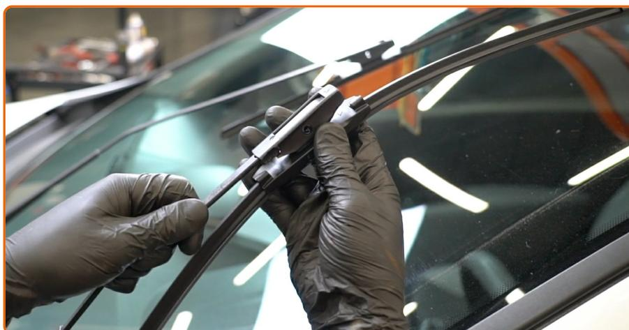
Installez la nouvelle lame d'essuie-glaces et reposez avec précaution le bras d'essuie-glace sur le pare-brises.
