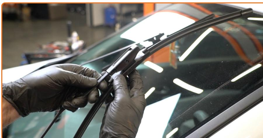
Tirez à fond sur le bras d'essuie-glace de la surface de la vitre jusqu'au maximum.
