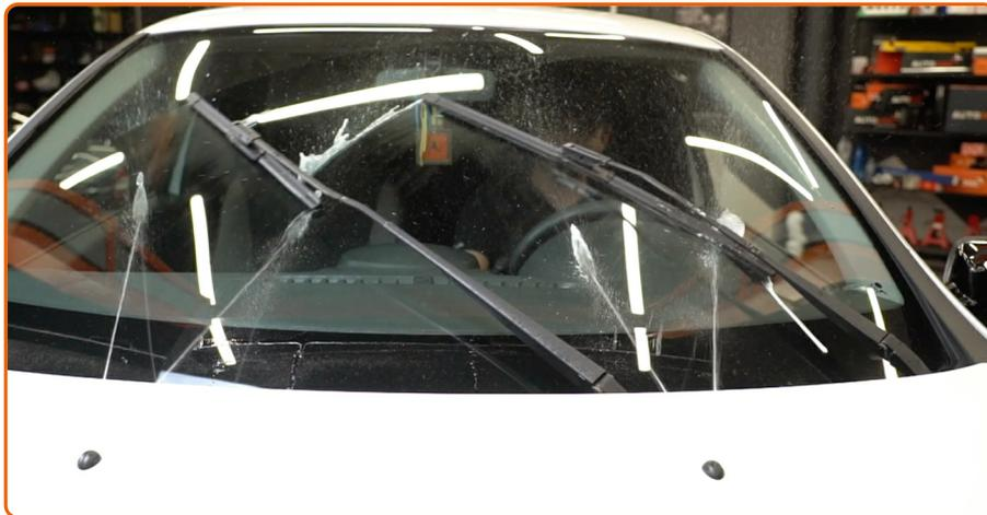
Après installation, vérifiez la performance des essuie-glaces. Les balais ne doivent pas s'entrechoquer ni cogner contre le joint du pare-brise.
