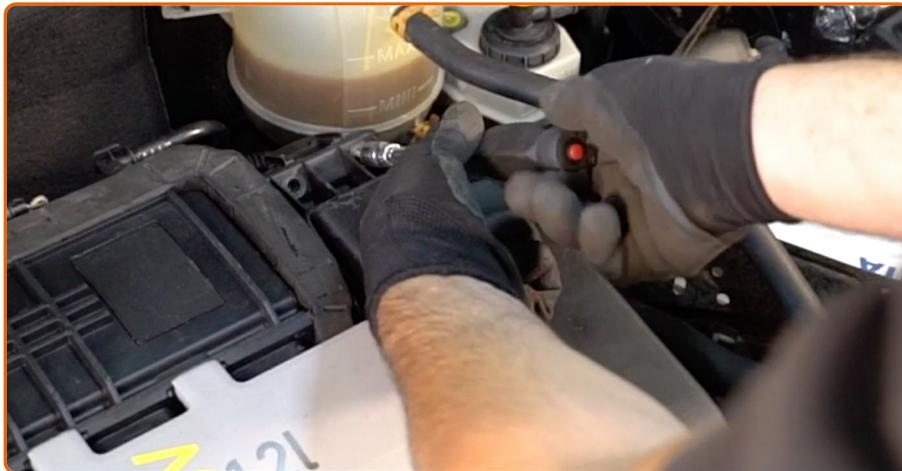
Vissez les trois vis de fixation du couvercle de filtre à air. Utilisez une douille n° 10. Utilisez une clé à cliquet.
