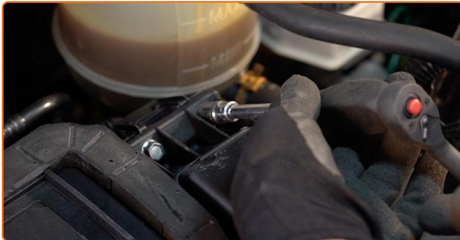
Desserrez les trois vis de fixation du couvercle de filtre à air. Utilisez une douille n° 10. Utilisez une clé à cliquet.
