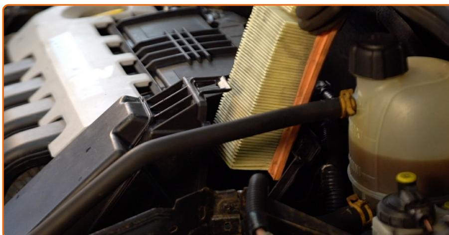
Retirez l'élément filtrant du compartiment du filtre.
