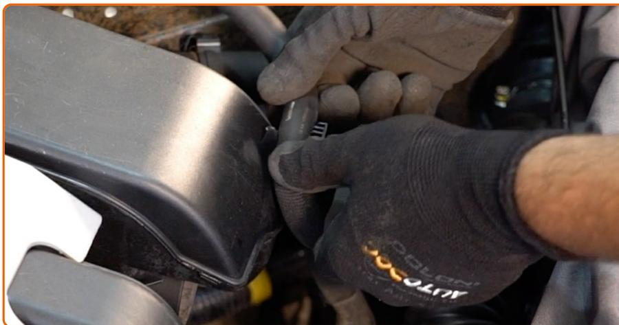
Reliez le tuyau du réservoir à liquide de refroidissement.
