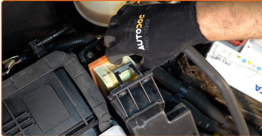
Insérez un nouvel élément filtrant dans le compartiment du filtre. Assurez-vous que le cadre du filtre s'insère de manière ferme dans le boîtier.
