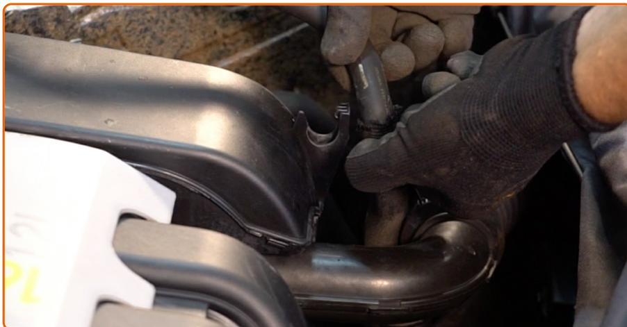
Détachez le tuyau du réservoir à liquide de refroidissement.
