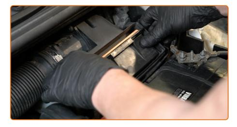
Réinstallez le compartiment du filtre à air.
