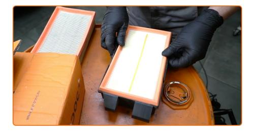
Insérez un nouvel élément filtrant dans le compartiment du filtre. Assurez-vous que le cadre du filtre s'insère de manière ferme dans le boitier.
