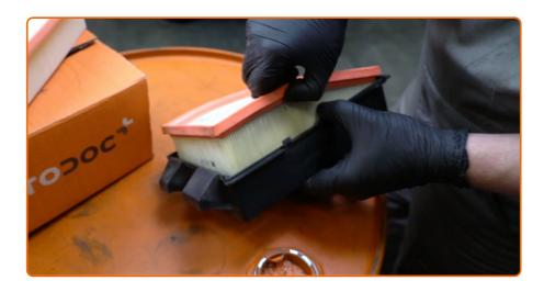
Retirez l'élément filtrant du compartment du filtre.
