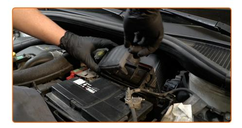
Réinstallez le couvercle du filtre à air. Fixez-le.
