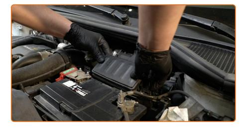
Appuyez sur les attaches du couvercle du filtre à air pour le remettre en place.
