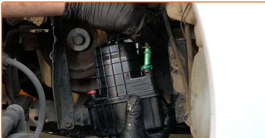
Connectez les lignes d'alimentation en carburant au filtre à carburant.
