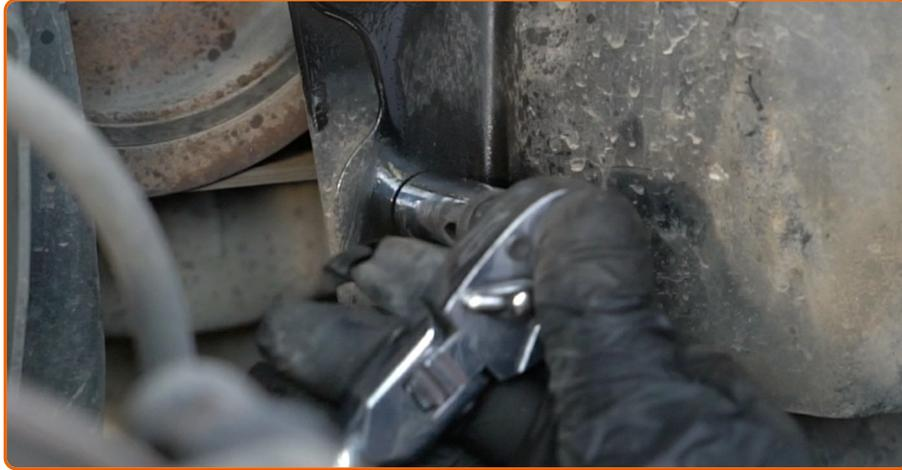
Dévissez les boulons de fixation du support du filtre à air. Utilisez une douille n° 13. Utilisez une clé à cliquet.
