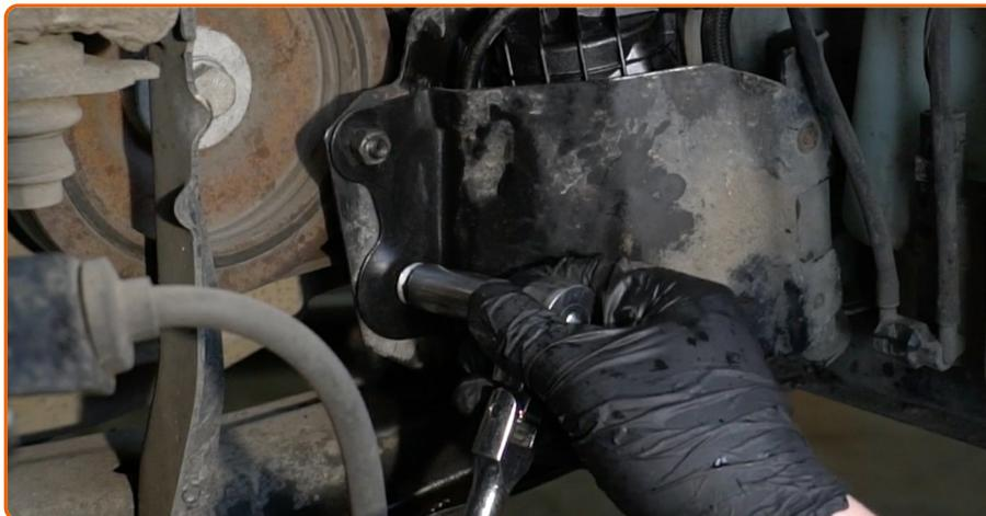
Vissez le boulons de fixation du support du filtre à carburant. Utilisez une douille n° 13. Utilisez une clé dynamométrique. Serrez-le jusqu'à 19 Nm.
