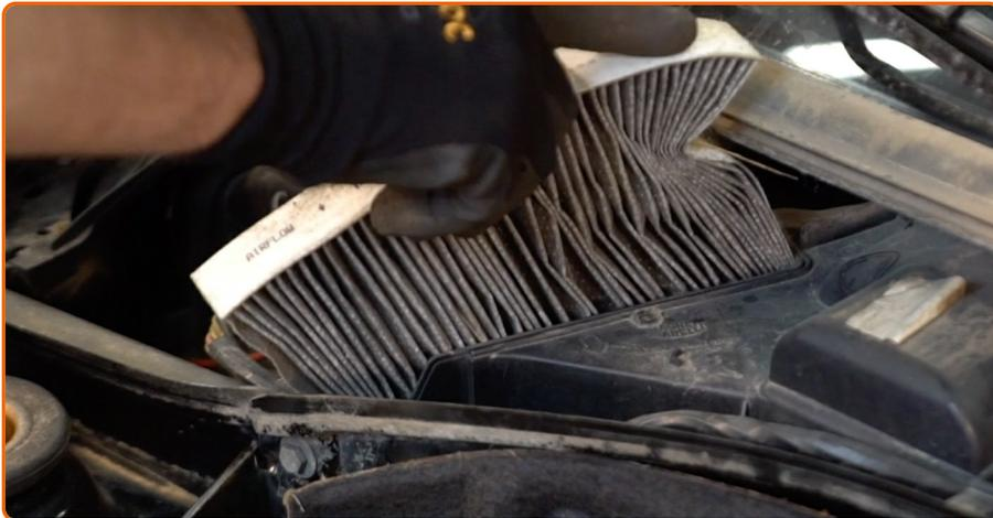
Retirez l'élément filtrant du compartiment du filtre.
