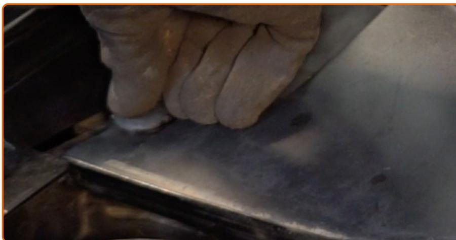
Installez les fixations sur le cache d'auvent.
