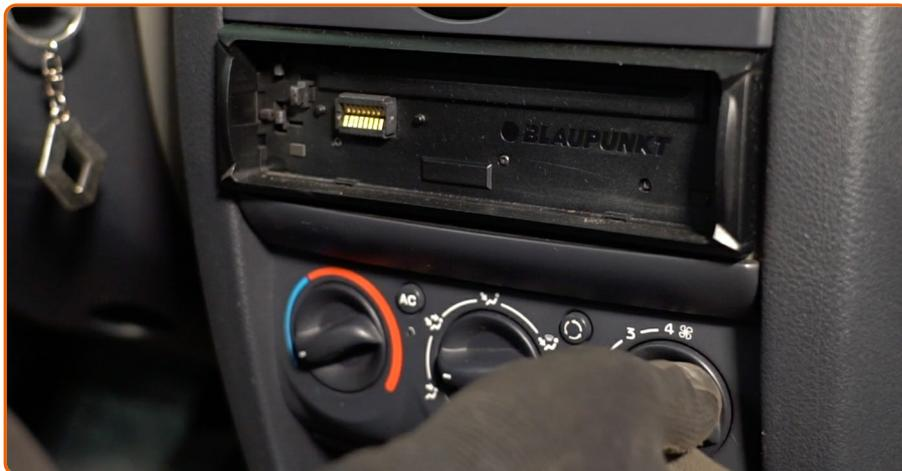
Activez la climatisation. C'est nécessaire pour s'assurer que le composant fonctionne correctement.
