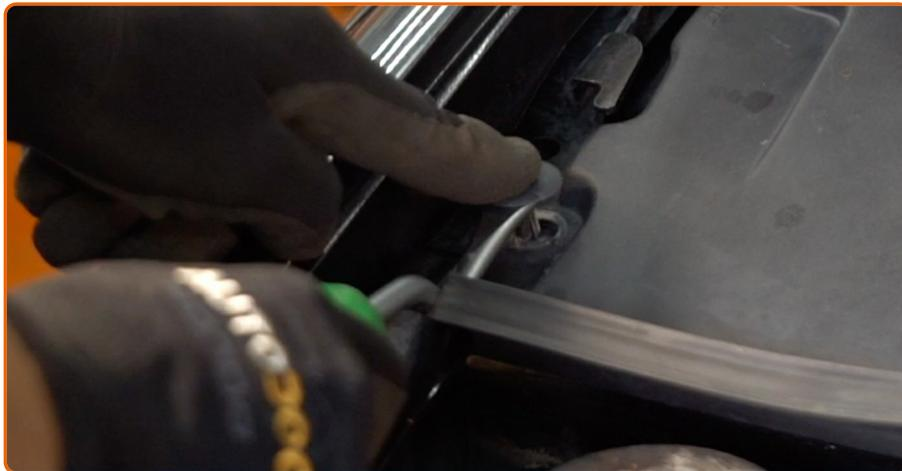
Retirez les clips de la grille d'auvent en plastique. Utilisez un outil d'extraction de clips.
