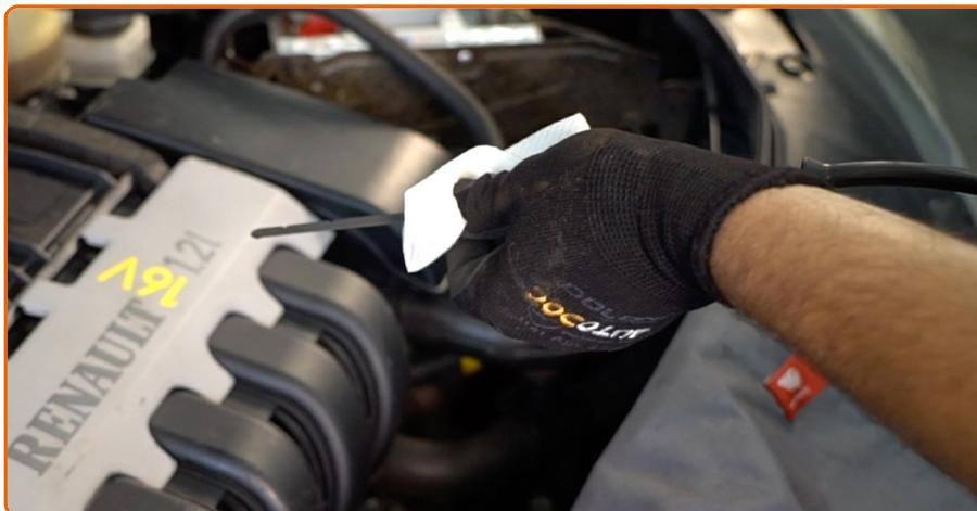
Vérifiez le niveau d'huile cinq minutes après l'arrêt du moteur à l'aide d'une jauge, et ajoutez de l'huile si nécessaire.
