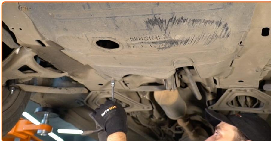
Défaites les attaches du carénage sous moteur. Utilisez une douille n° 10. Utilisez une clé à cliquet.
