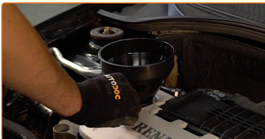
Retirez le bouchon du bec de remplissage d'huile. Insérez l'entonnoir.
