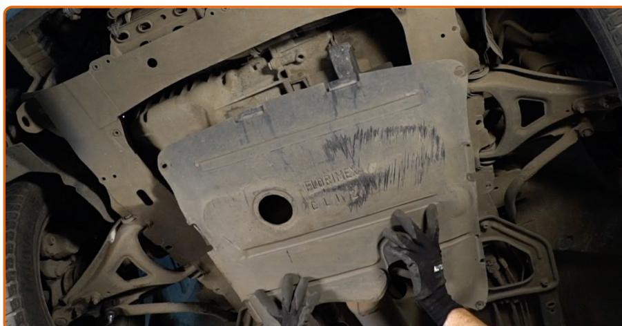
Retirez le carénage sous moteur.
