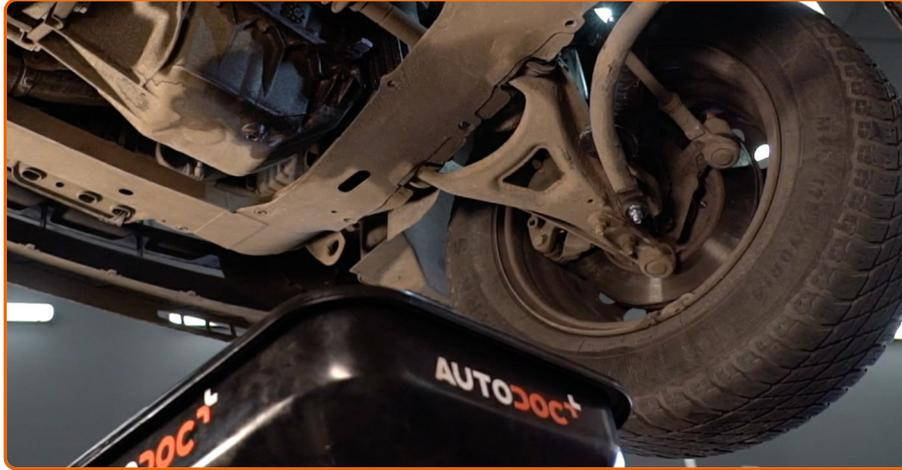
Placez un contenant d'huile de vidange d'une capacité de 5 l minimum sous l'orifice de drainage.
