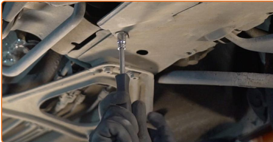
Serrez les fixations du carénage sous moteur. Utilisez une douille n° 10. Utilisez une clé à cliquet.
