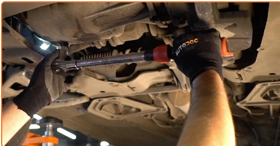
Vissez le nouveau bouchon de vidange et le resserrez. Servez-vous d'une douille de vidange carrée n°8. Utilisez une clé dynamométrique. Serrez-le jusqu'à 23 Nm.
