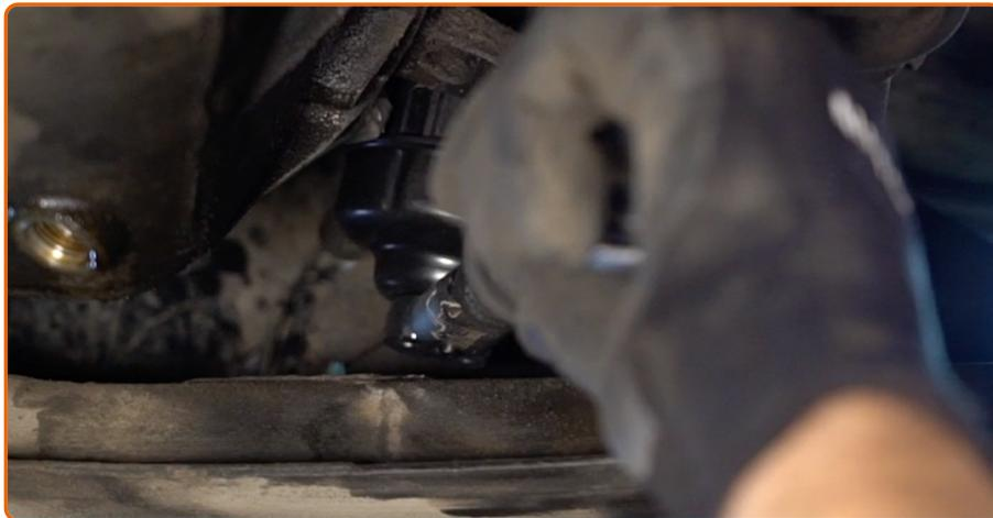
Vissez le filtre neuf en place. Utilisez la douille 66-6F. Utilisez une clé dynamométrique. Serrez jusqu'à 25 Nm.
