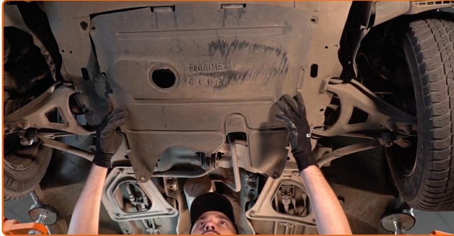
Remettez en place le carénage sous moteur.
