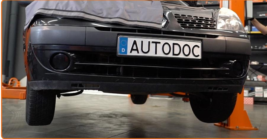
Soulevez la voiture en vous servant d'un cric ou en l'installant sur une fosse mécanique.
