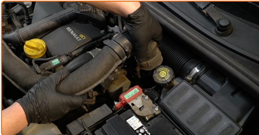
Déconnectez le tuyau d'admission d'air du boîtier du filtre à air.
