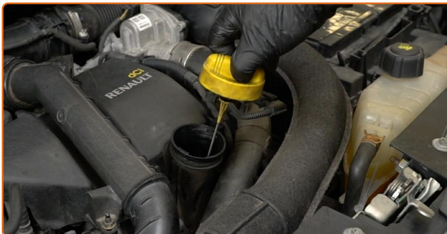
Retirez le bouchon du bec de remplissage d'huile.
