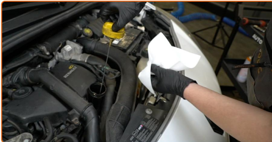
Mesurez le niveau d'huile avec la jauge à huile. Ajoutez de l'huile si nécessaire.
