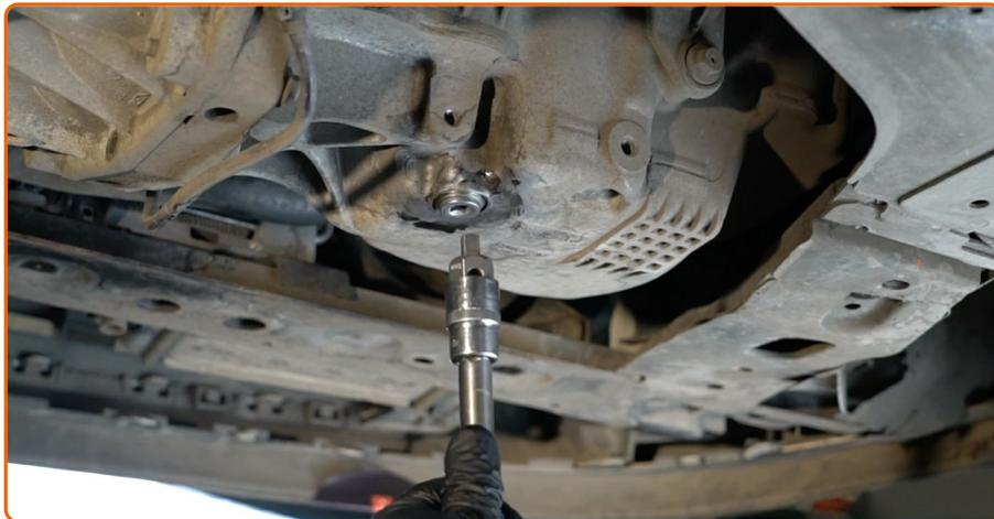
Vissez le nouveau bouchon de vidange et le resserrez. Servez-vous d'une douille de vidange carrée n°8. Utilisez une clé dynamométrique. Serrez-le jusqu'à 27 Nm.
