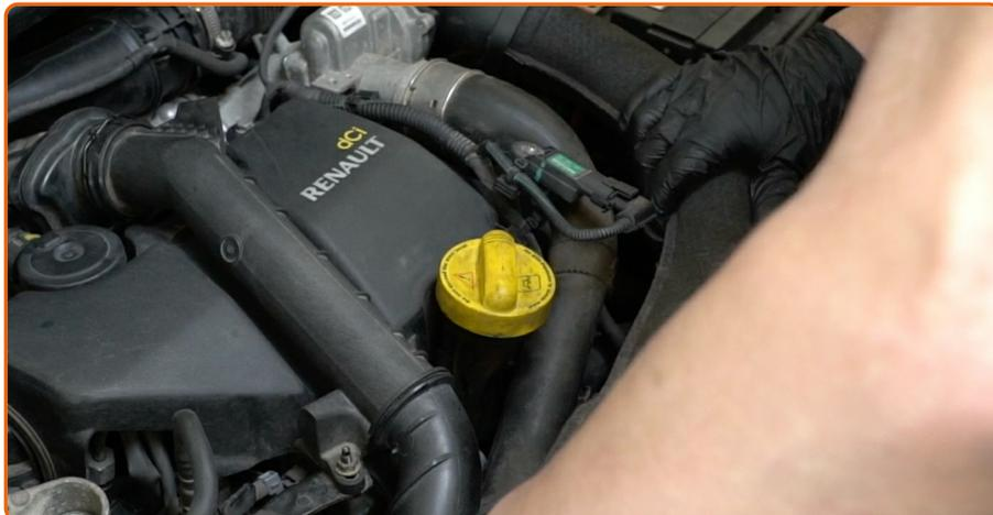
Connectez le tuyau d'admission d'air au boîtier du filtre à air.
