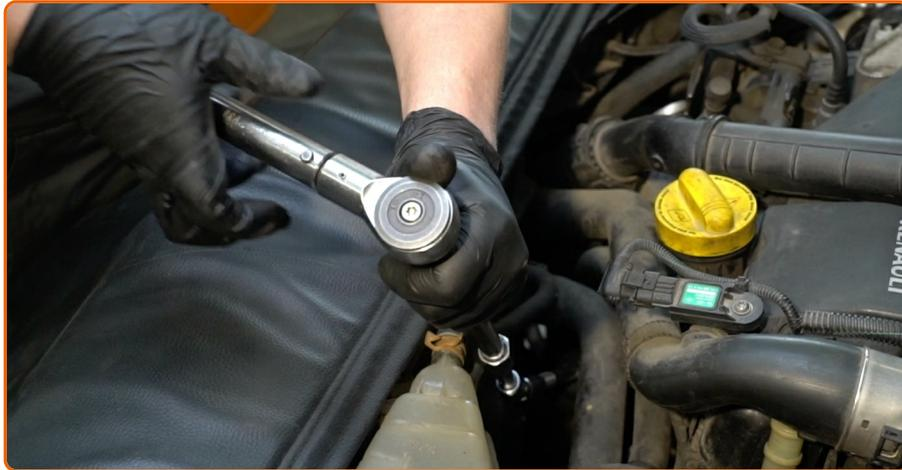
Vissez le filtre neuf en place. Utilisez la douille 76-14F. Utilisez une clé dynamométrique. Serrez-le jusqu'à 25 Nm.
