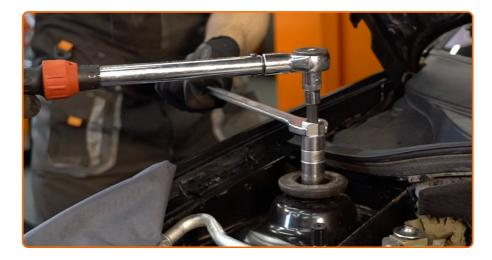
Serrez l'attache supérieure de l'entretoise de support de l'amortisseur. Utilisez une douille n° 21. Utilisez la clé HEX n° H6. Utilisez une clé dynamométrique. Serrez-le jusqu'à 55 Nm.
