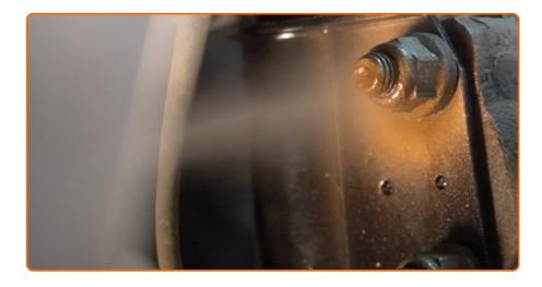
Appliquez du produit sur les fixations de l'amortisseur. Utilisez de la graisse au cuivre.
