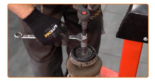
Retirez l'écrou de la tige de piston de l'entretoise. Utilisez une douille n° 17. Utilisez la clé HEX n° H6. Utilisez une clé à cliquet.
