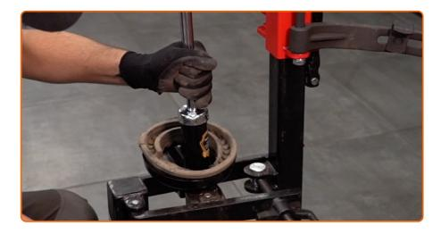
Installez le nouvel amortisseur sur le compresseur à ressort hydraulique hélicoïdal.
