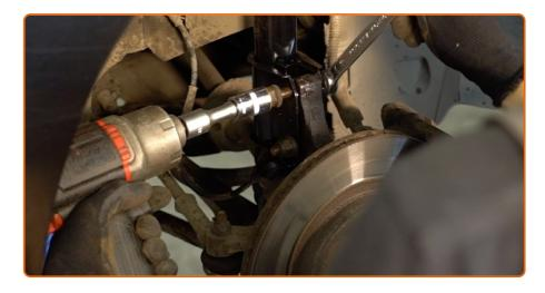
Vissez la fixation qui relie la jambe d'amortisseur à la fusée d'essieu. Utilisez une clé mixte de No.18. Utilisez une douille n° 18.
