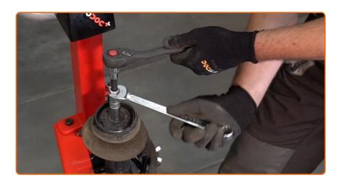
Serrez l'écrou de l'entretoise d'amortisseur due la tige de piston. Utilisez une douille n° 17. Utilisez la clé HEX n° H6. Utilisez une clé dynamométrique. Serrez-le jusqu'à 60 Nm.
