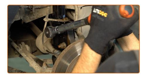
Serrez les fixations inférieures qui relient l'amortisseur à la fusée d'essieu. Utilisez une clé mixte de No.18 Utilisez une douille n° 18. Utilisez une clé dynamométrique. Serrez-le jusqu'à 110 Nm.
