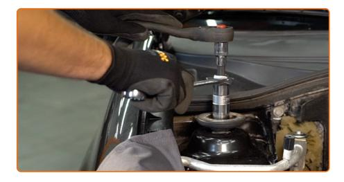
Devissez la fixation supérieure du support d'amortisseur. Utilisez la clé HEX n° H6. Utilisez une clé mixte de No.21 Utilisez une clé à cliquet.
