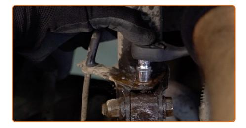
Dévissez le support de câble ABS. Utilisez une douille n° 10. Utilisez une clé à cliquet.
