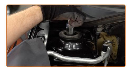
Dévissez l'attache supérieure du support de l'amortisseur. Utilisez une douille n° 21.
