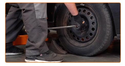
Desserrez les boulons de fixation de la roue. Servez-vous d'une douille à choc pour roue  $N^{\circ}19$ .
