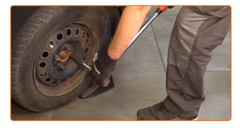
Serrez en étoile les boulons de la roue. Utilisez une clé dynamométrique. Serrez-le jusqu'à 120 Nm.
