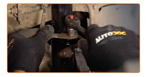
Serrez le support de câble ABS. Utilisez une douille n° 10. Utilisez une clé à cliquet.
