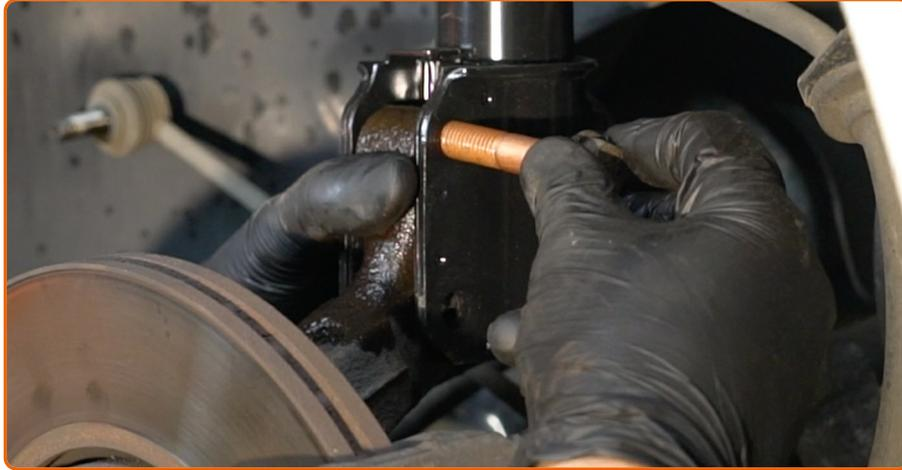
Installez les boulons de fixation.
