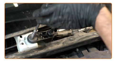
Serrez les fixations de la tringlerie d'essuie-glace. Utilisez une douille n° 10. Utilisez une clé dynamométrique. Serrez-le jusqu'à 22 Nm.
