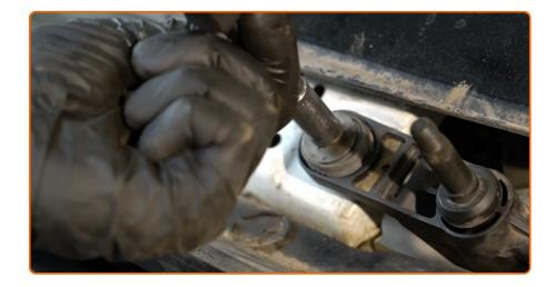
Vissez les fixations de la tringlerie d'essuie-glace. Utilisez une douille n° 10. Utilisez une clé à cliquet.
