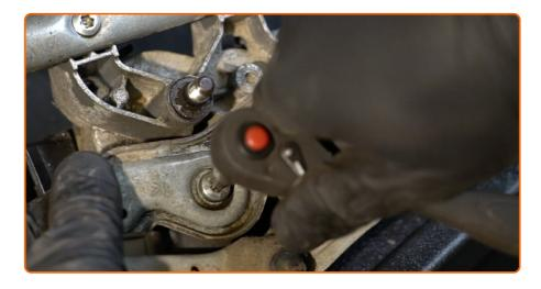
Dévissez les fixations du moteur d'essuie-glace. Utilisez la mèche Torx T30. Utilisez une clé à cliquet.
