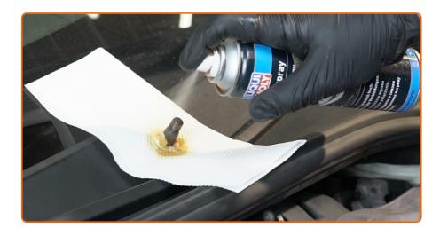
Appliquez du produit sur les pivots des bras d'essuie-glaces. Utilisez de la graisse au cuivre.
