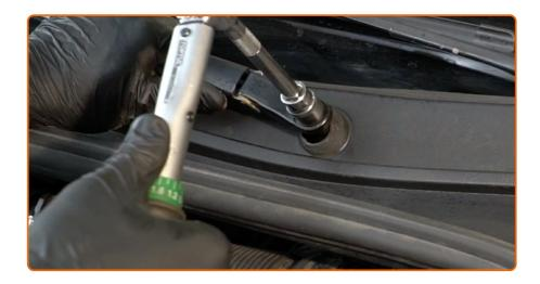
Serrez les fixations des bras d'essuie-glaces. Utilisez une douille n° 16. Utilisez une clé dynamométrique. Serrez-le jusqu'à 29 Nm.
