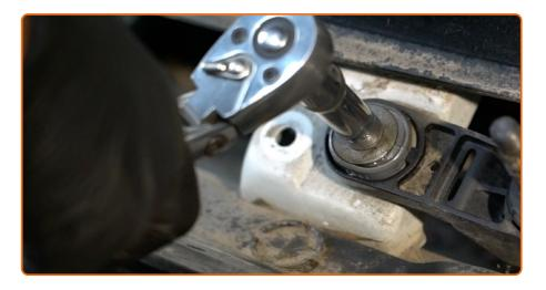
Dévissez les fixations de la tringlerie d'essuie-glace. Utilisez une douille n° 10. Utilisez une clé à cliquet.
