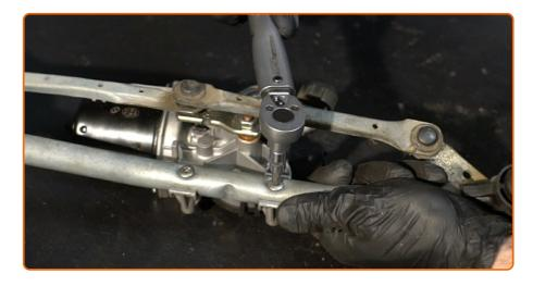
Serrez les fixations du moteur d'essuie-glace. Utilisez la mèche Torx T30. Utilisez une clé dynamométrique. Serrez-le jusqu'à 24 Nm.
