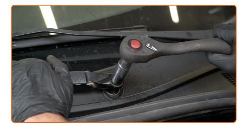
Dévissez les fixations des bras d'essuie-glaces. Utilisez une douille n° 16. Utilisez une clé à cliquet.
