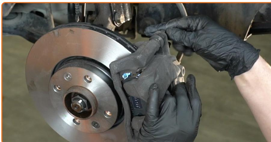
Installez l'étrier de frein et fixez-le. Utilisez une clé mixte de No.13 Utilisez une clé mixte de No.19 Utilisez une douille n° 13. Utilisez une clé dynamométrique. Serrez-le jusqu'à 35 Nm.
