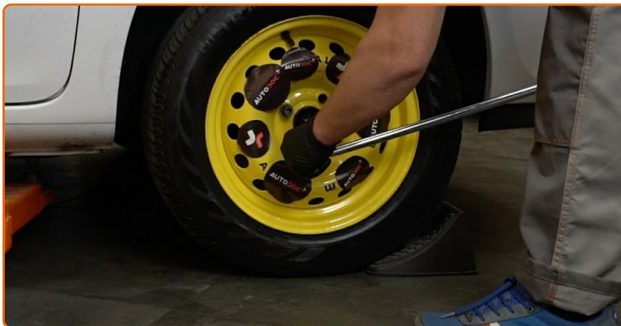
Desserrez les boulons de fixation de la roue. Servez-vous d'une douille à choc pour roue N°17.
