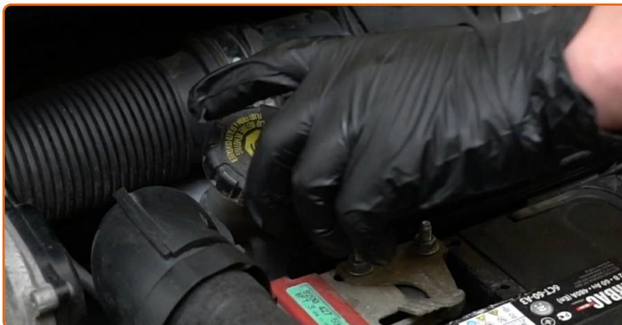
Dévissez le bouchon du réservoir de liquide de frein.
