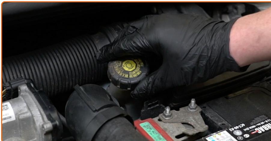
Resserez le bouchon du réservoir de liquide de frein.
