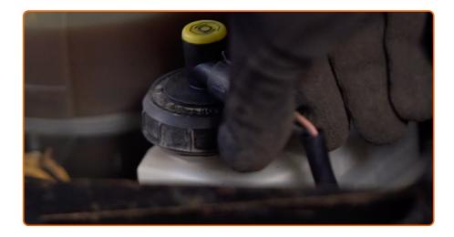
Resserez le bouchon du réservoir de liquide de frein. Fermez le capot.
