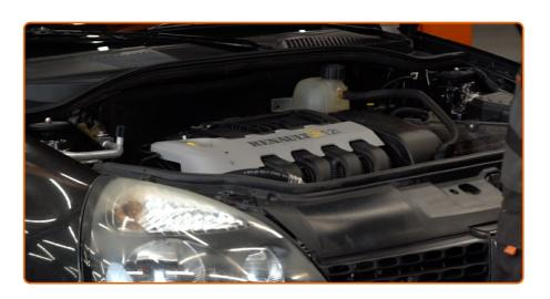
Ouvrez le capot. Dévissez le bouchon du réservoir de liquide de frein.
