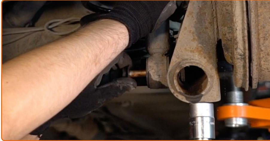
Installez l'écrou de fixation.
