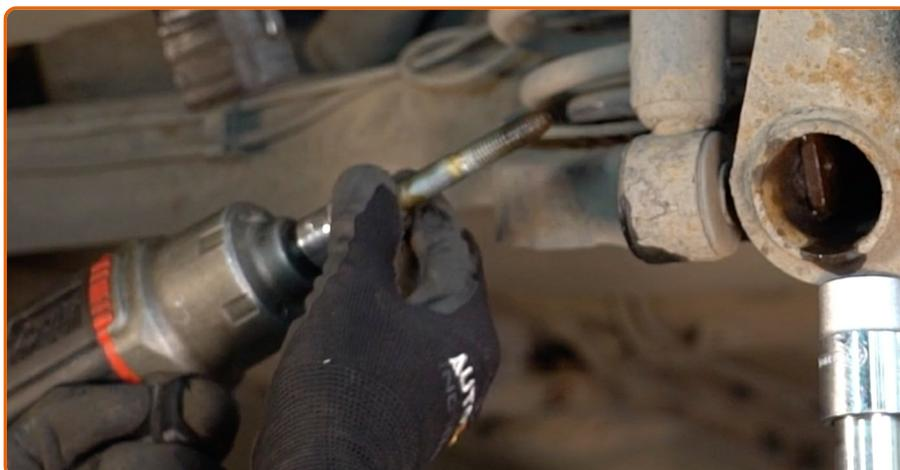
Retirez l'écrou de fixation.
