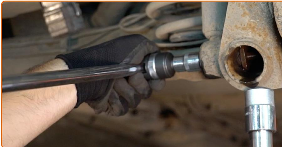
Dévissez l'attache inférieure de l'amortisseur. Utilisez une douille n° 18.
