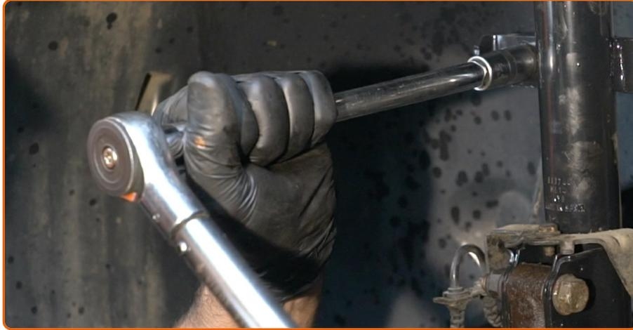
Serrez la fixation reliant la biellette à l'amortisseur. Utilisez une douille n° 16. Utilisez une clé dynamométrique. Serrez-le jusqu'à 65 Nm.
