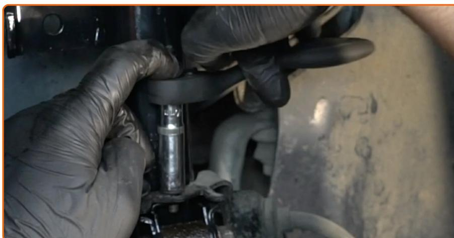
Serrez le collier de serrage du flexible de frein de l'entretoise de l'amortisseur. Utilisez une douille n° 10. Utilisez une clé à cliquet.
