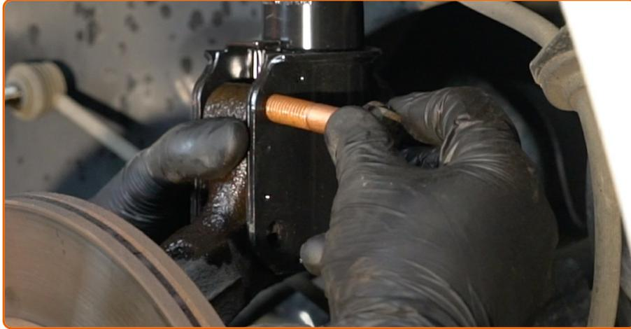
Installez les boulons de fixation.
