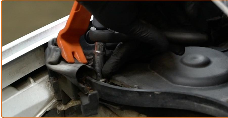
Dévissez les fixations du couvercle du support de la jambe de suspension. Utilisez une douille n° 10. Utilisez une clé à cliquet.
