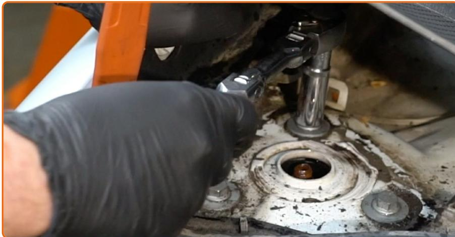
Devissez la fixation supérieure du support d'amortisseur. Utilisez une douille n° 13. Utilisez une clé à cliquet.
