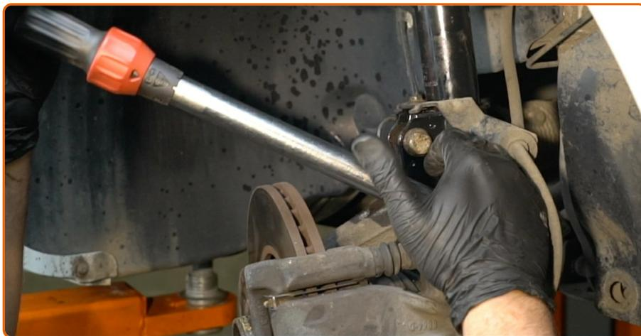
Serrez les fixations inférieures qui relient l'amortisseur à la fusée d'essieu. Utilisez une clé mixte de No.18 Utilisez une douille n° 18. Utilisez une clé dynamométrique. Serrez-le jusqu'à 105 Nm.
