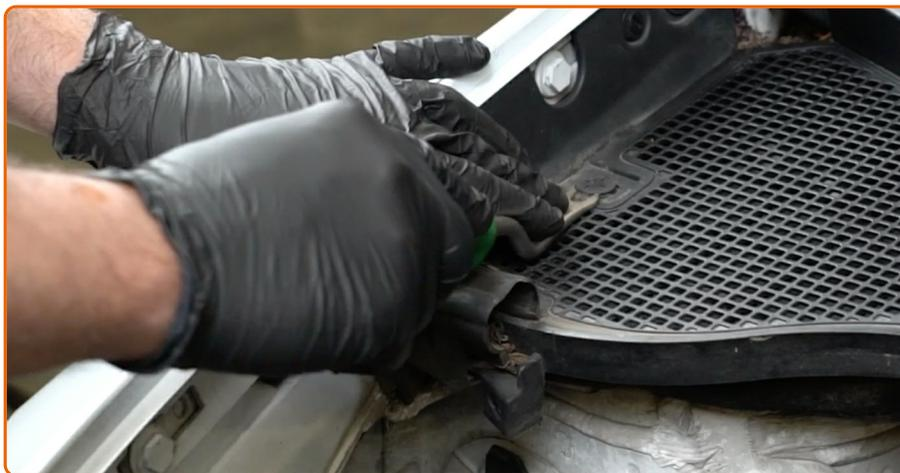
Retirez les clips du cache d'auvent. Utilisez un outil d'extraction de clips.
