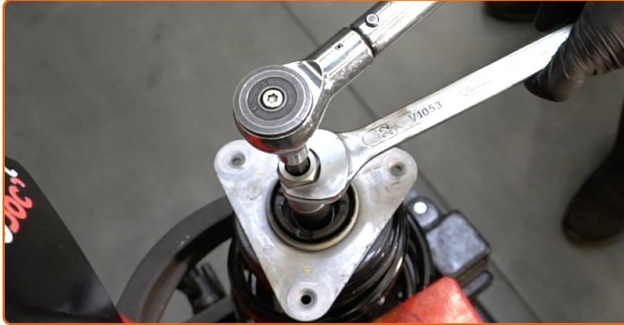
Serrez l'écrou de l'entretoise d'amortisseur due la tige de piston. Utilisez une douille n° 18. Utilisez la clé HEX n° H6. Utilisez une clé dynamométrique. Serrez-le jusqu'à 64 Nm.
