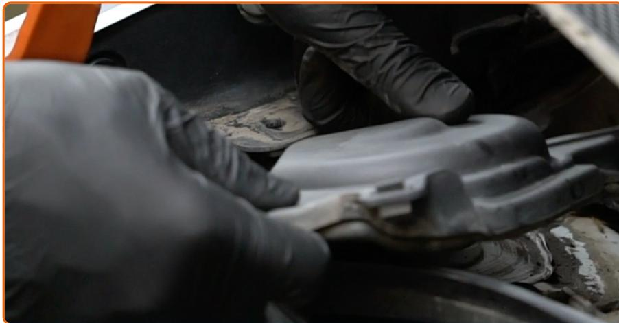
Retirez le bouchon de protection du support d'amortisseur.
