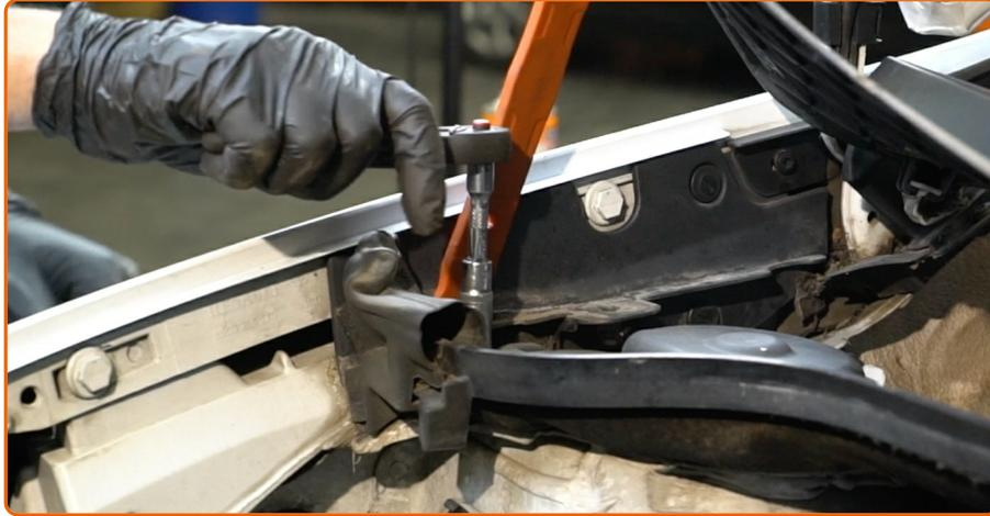
Vissez les fixations du couvercle du support de la jambe de suspension. Utilisez une douille n° 10. Utilisez une clé à cliquet.
