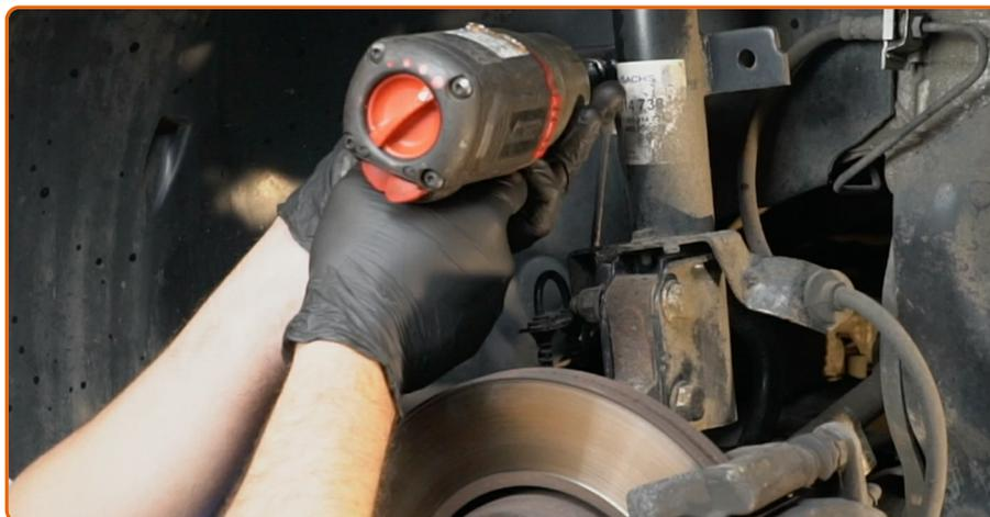
Dévissez la fixation reliant la biellette à l'amortisseur. Utilisez une douille n° 16. Utilisez une clé à cliquet.
