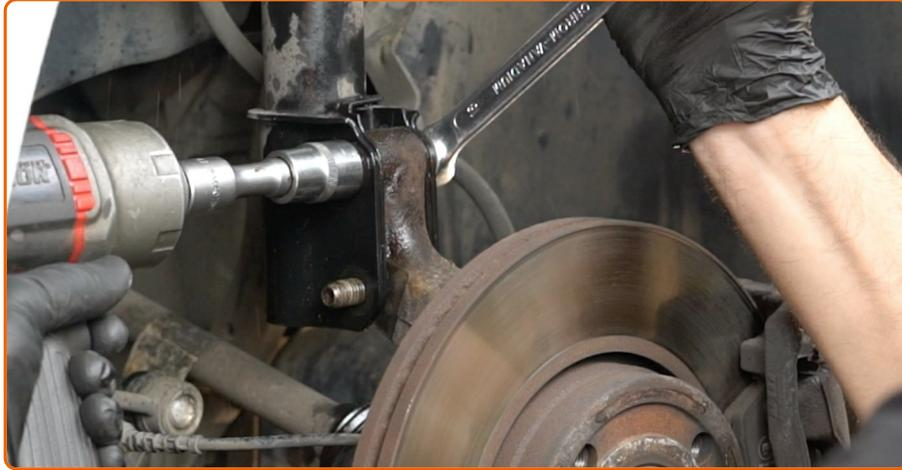
Dévissez la fixation inférieure assurant la connexion entre la jambe d'amortisseur et le porte-fusée. Utilisez une clé mixte de No.18 Utilisez une douille n° 18. Utilisez un porte-taraud.
