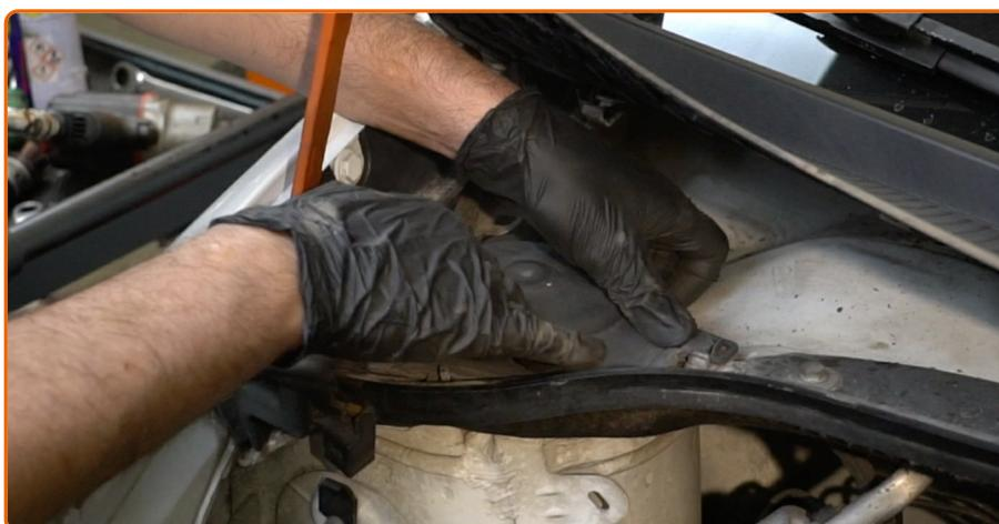
Installez le bouchon de protection du support d'amortisseur.
