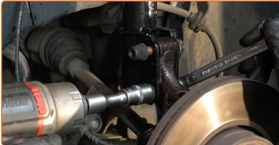
Vissez la fixation qui relie la jambe d'amortisseur à la fusée d'essieu. Utilisez une clé mixte de No.18 Utilisez une douille n° 18. Utilisez une clé à cliquet.
