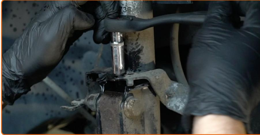
Dévissez le collier de serrage flexible de frein de l'entretoise de l'amortisseur. Utilisez une douille n° 10. Utilisez une clé à cliquet.
