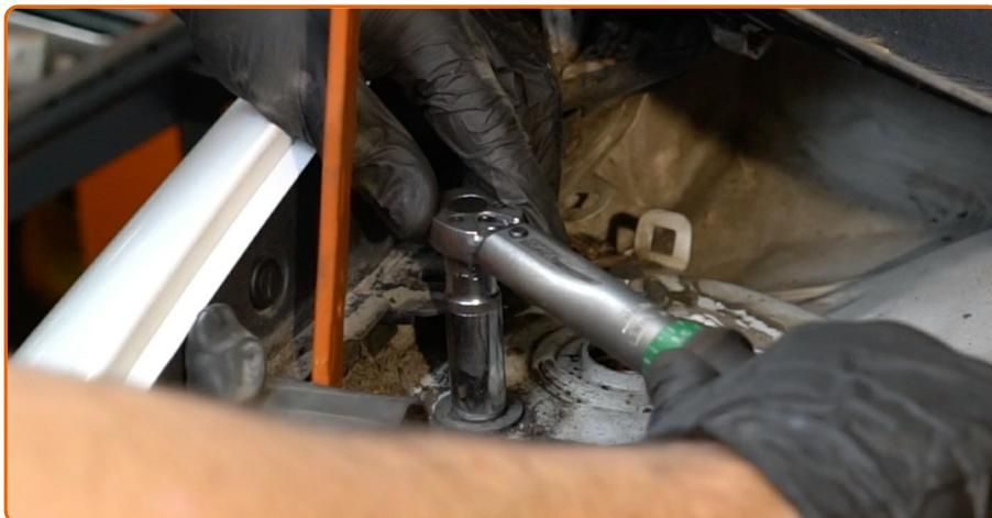
Serrez l'attache supérieure de l'entretoise de support de l'amortisseur. Utilisez une douille n° 13. Utilisez une clé dynamométrique. Serrez-le jusqu'à 47 Nm.
