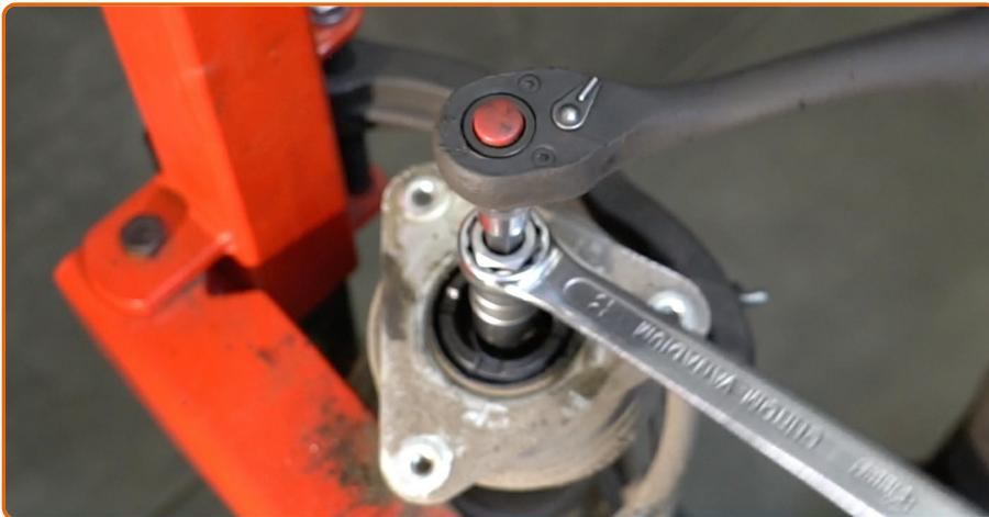
Retirez l'écrou de la tige de piston de l'entretoise. Utilisez la clé HEX n° H6. Utilisez une douille n° 18. Utilisez une clé à cliquet.
