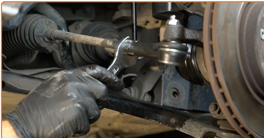
Vissez le contre-écrou de l'embout de biellette de direction. Utilisez une clé mixte de No.21 (2 pièces).
