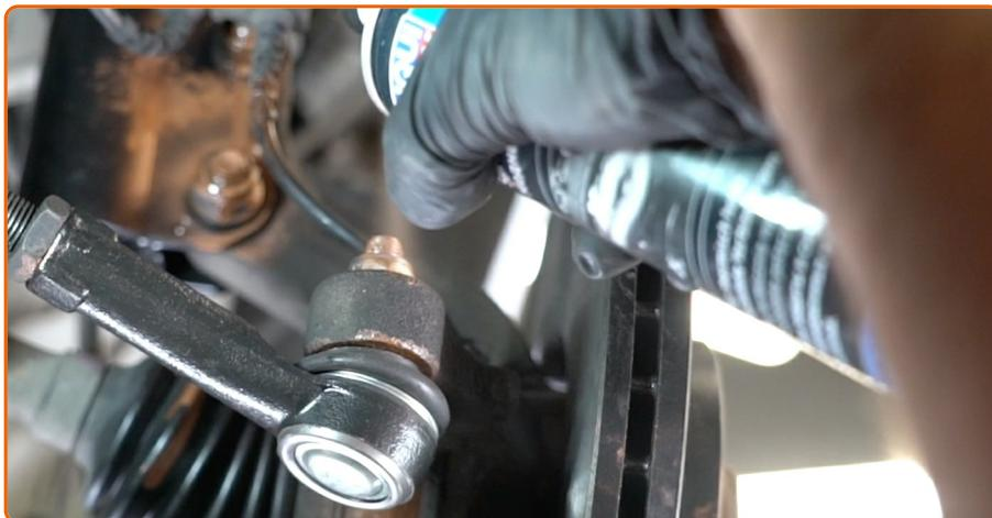
Appliquez du produit sur la fixation reliant l'embout de biellette de direction à la fusée d'essieu. Utilisez de la graisse au cuivre.
