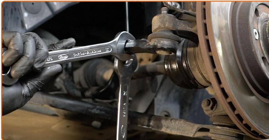
Désérrez l'écrou de blocage qui retient l'extrémité de la barre stabilisatrice à la barre stabilisatrice. Utilisez une clé mixte de No.21 (2 pièces).
