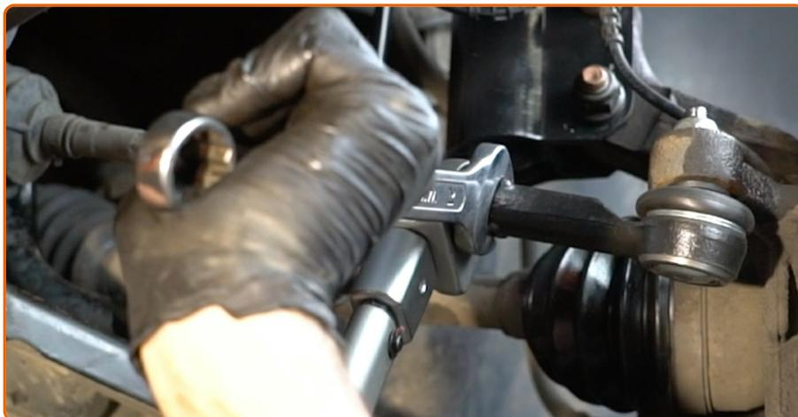
Serrez l'écrou de blocage de l'extrémité de la barre. Utilisez une clé mixte de No.21 (2 pièces). Utilisez une clé dynamométrique. Serrez-le jusqu'à 65 Nm.
