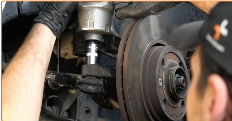
Dévissez l'écrou d'attache d'extrémité à la fusée d'essieu. Utilisez une douille n° 16. Utilisez un porte-taraud.
