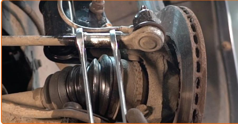
Désérrez l'écrou de blocage qui retient l'extrémité de la barre stabilisatrice à la barre stabilisatrice. Utilisez une clé mixte de No.20 Utilisez une clé mixte de No.22
