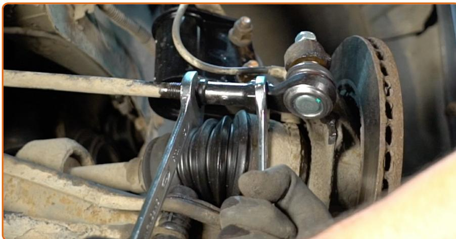
Vissez le contre-écrou de l'embout de biellette de direction. Utilisez une clé mixte de No.20
