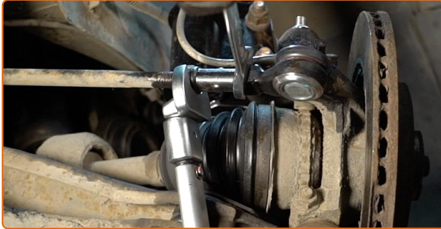
Serrez l'écrou de blocage de l'extrémité de la barre. Utilisez une clé mixte de No.20 Utilisez une clé mixte de No.22 Utilisez une clé dynamométrique. Serrez-le jusqu'à 55 Nm.
