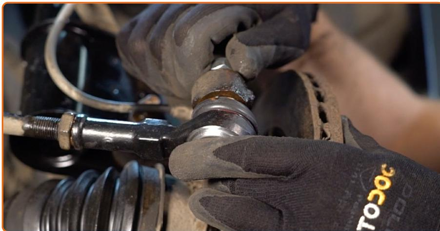
Connectez l'extrémité du tirant à la fusée d'essieu.
