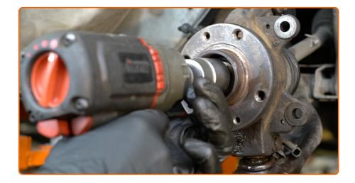
Vissez l'écrou à l'arbre d'entrainement. Utilisez une douille n° 30. Utilisez une clé à cliquet.
