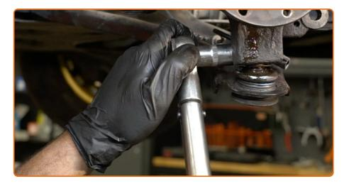
Serrez l'attache du joint rotule. Utilisez une clé mixte de No.16 Utilisez une douille n° 16. Utilisez une clé dynamométrique. Serrez-le jusqu'à 62 Nm.
