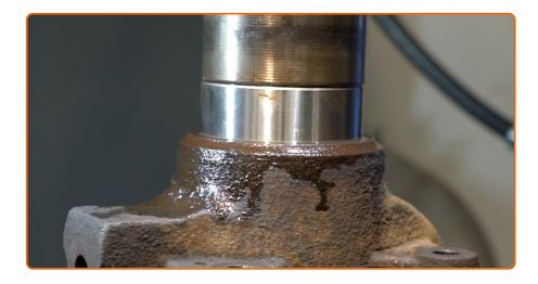
Appuyez sur le roulement neuf pour l'insérer dans la fusée d'essieu. Servez-vous d'un coffret de douilles et de roulements.
