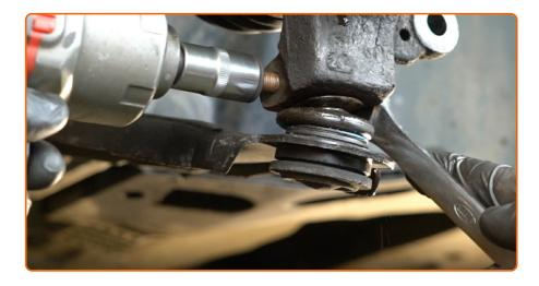
Vissez les fixations de la rotule. Utilisez une clé mixte de No.16 Utilisez une douille n° 16. Utilisez un porte-taraud.
