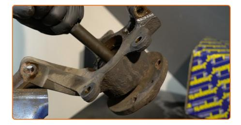
Retirez le moyeu de roue de la fusée d'essieu. Servez-vous d'un poinçon effilé. Servez-vous d'un marteau.
