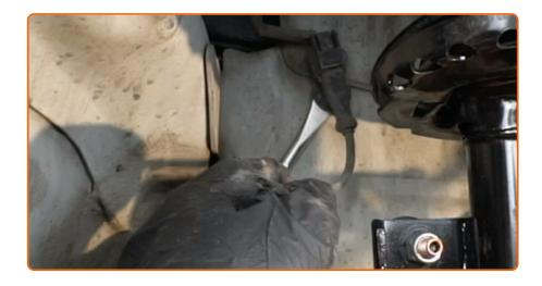
Débranchez les fils du capteur d'ABS. Utilisez un outil d'extraction de clips.
