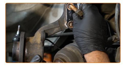
Installez les boulons de fixation.
