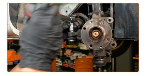
Serrez l'écrou de fixation reliant l'embout de biellette de direction à la fusée d'essieu. Utilisez une douille n° 17. Utilisez une clé dynamométrique. Serrez-le jusqu'à 70 Nm.
