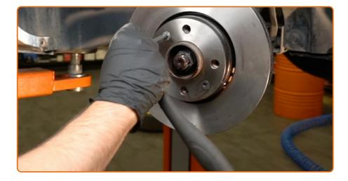
Dévissez l'attache du disque de frein. Utilisez la mèche Torx T30. Utilisez une clé à cliquet.
