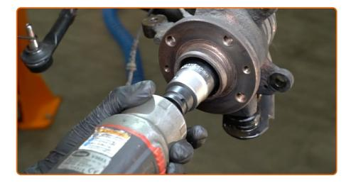
Dévissez les fixations qui lient l'arbre de transmission au moyeu de roue. Utilisez une douille n° 30. Utilisez une clé à cliquet.
