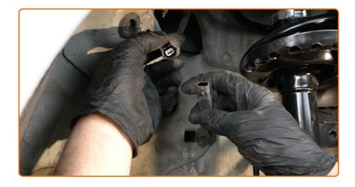
Détachez le connecteur du capteur ABS.
