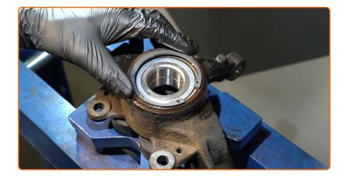
Installez l'anneau de retenue du palier du moyeu de roue. Utilisez les pinces à anneau de retenue.
