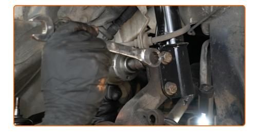
Dévissez la fixation inférieure assurant la connexion entre la jambe d'amortisseur et le portefusée. Utilisez une clé mixte de No.18 Utilisez une douille n° 18. Utilisez une clé à cliquet.
