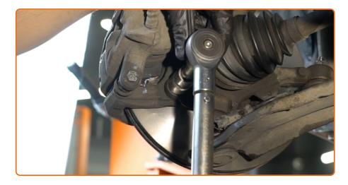
Serrez le support de l'étrier de frein. Utilisez une douille n° 18. Utilisez une clé dynamométrique. Serrez-le jusqu'à 85 Nm.
