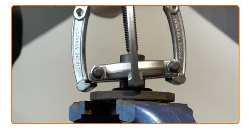
Tirez la bague de roulement intérieure du moyeu de roue. Servez-vous d'un extracteur d'engrenage à 3 bras. Utilisez un séparateur de roulement.
