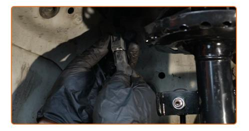
Attachez le connecteur du capteur ABS.
