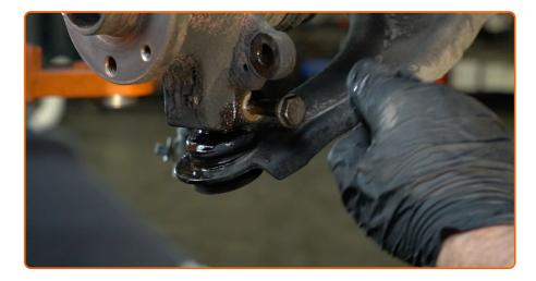
Retirez l'écrou de fixation.
