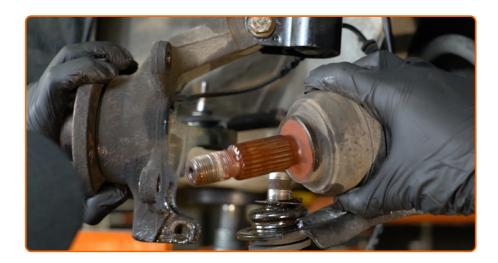
Détachez l'arbre de transmission de la fusée d'essieu.
