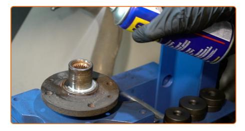
Traitez les attaches du roulement de moyeu de roue. Servez vous de l'aérosol WD-40.
