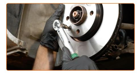
Serrez l'attache du disque de frein. Utilisez la mèche Torx T30. Utilisez une clé dynamométrique. Serrez-le jusqu'à 9 Nm.
