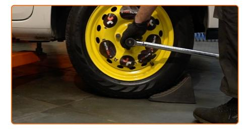
Resserrez l'écrou de l'arbre de transmission. Utilisez une douille n° 30. Utilisez une clé dynamométrique. Serrez-le jusqu'à 162 Nm.
