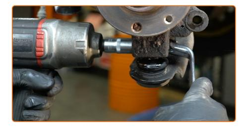
Dévissez l'attache entre le joint rotule et la fusée d'essieu. Utilisez une clé mixte de No.16 Utilisez une douille n° 16. Utilisez un porte-taraud.
