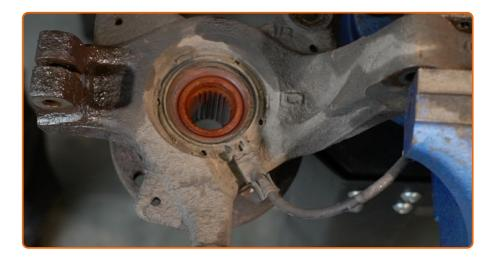
Agrippez le moyeu de roue avec les roulements en vous servant d'un étau.
