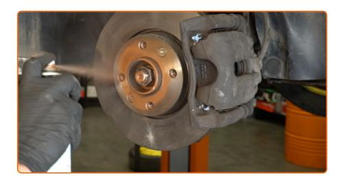
Appliquez du produit sur la zone de contact entre le disque de frein et la jante. Utilisez de la graisse au cuivre.
