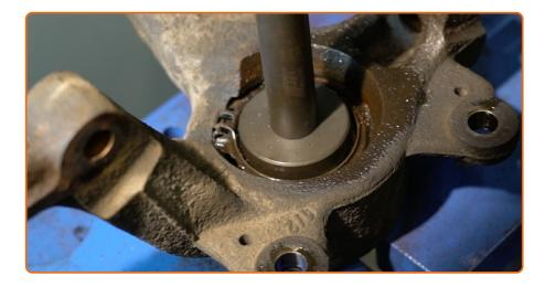
Faites sortir le palier du moyeu de roue. Servez-vous d'un coffret de douilles et de roulements.
