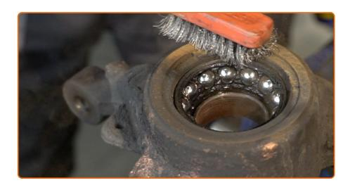
Nettoyez la bague de retenue du roulement de moyeu de la roue. Utilisez une brosse métallique. Servez vous de l'aérosol WD-40.
