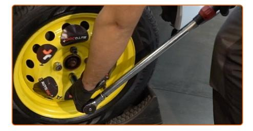
Serrez en étoile les boulons de la roue. Servez-vous d'une douille à choc pour roue N°17. Utilisez une clé dynamométrique. Serrez-le jusqu'à 120 Nm.
