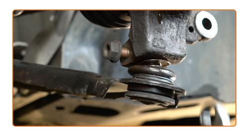
Installez l'écrou de fixation.
