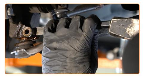
Détendez les fixations reliant le joint à rotule du bras de commande à la fusée d'essieu. Servez-vous d'un burin plat pour l'usinage des métaux. Servez-vous d'un marteau.
