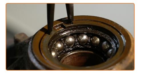
Retirez l'anneau de retenue du palier de moyeu de roue. Utilisez les pinces à anneau de retenue. Utilisez un tournevis plat.
