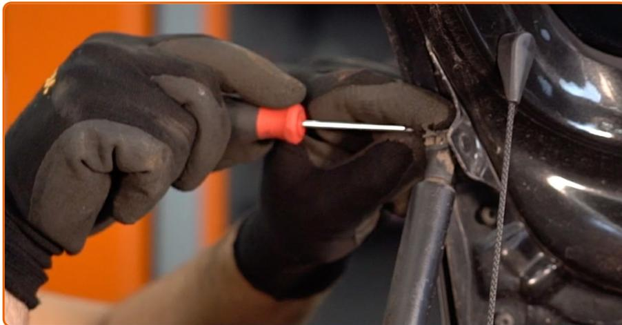
Détendez l'anneau de retenue reliant le vérin à gaz au couvercle de coffre. Utilisez un tournevis plat.
